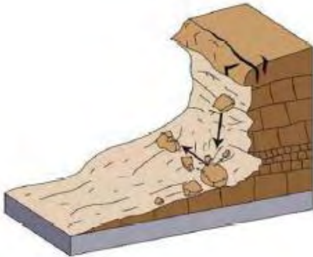
Σχήμα 3.6: Καταπτώσεις βράχων (U.S. Geological Survey, 2004).
