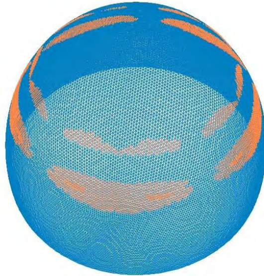
Σχήμα 3.36 Ράβδοι που έχουν αστοχήσει μέχρι το 8 ο βήμα (με πορτοκαλί)
