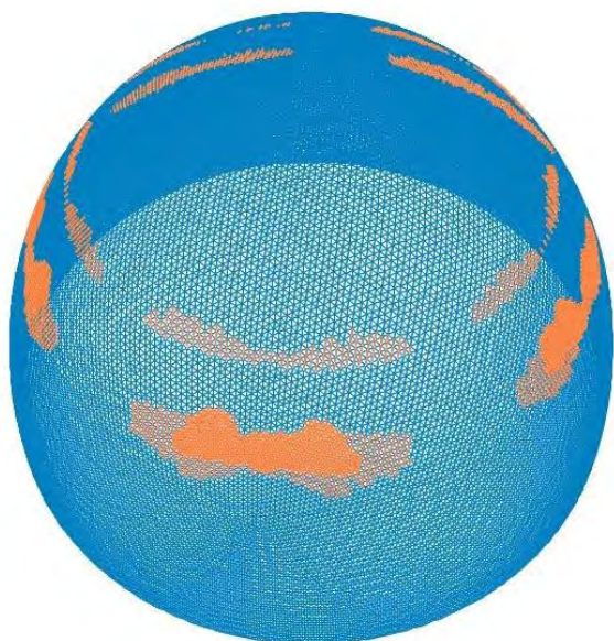
Σχήμα 3.14 Ράβδοι που έχουν αστοχήσει μέχρι το 4 ο βήμα (με πορτοκαλί)
