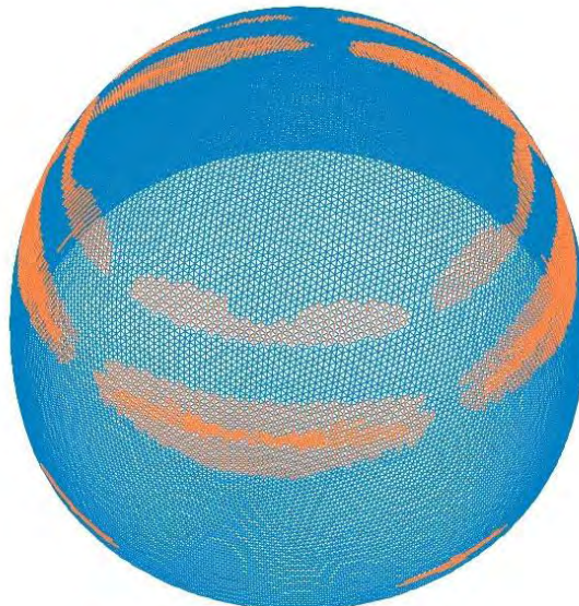
Σχήμα 3.39 Ράβδοι που έχουν αστοχήσει μέχρι το 11° βήμα (με πορτοκαλί)
