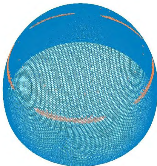
Σχήμα 3.30 Ράβδοι που έχουν αστοχήσει μέχρι το 2 ο βήμα (με πορτοκαλί)
