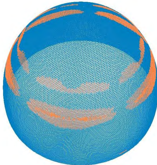
Σχήμα 3.37 Ράβδοι που έχουν αστοχήσει μέχρι το 9 ο βήμα (με πορτοκαλί)
