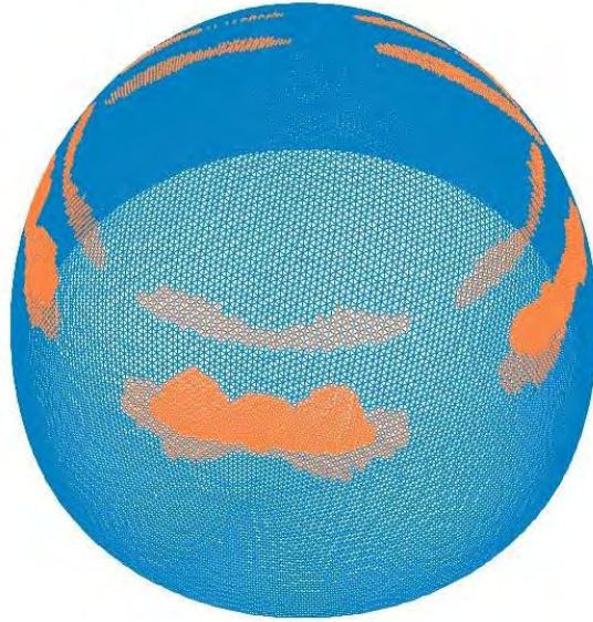
Σχήμα 3.15 Ράβδοι που έχουν αστοχήσει μέχρι το 5° βήμα (με πορτοκαλί)
