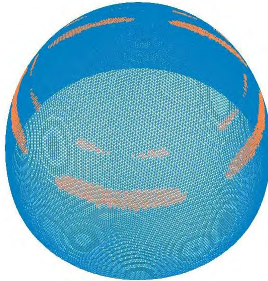
Σχήμα 3.32 Ράβδοι που έχουν αστοχήσει μέχρι το 4 ο βήμα (με πορτοκαλί)
