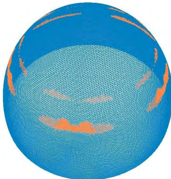
Σχήμα 3.13 Ράβδοι που έχουν αστοχήσει μέχρι το 3 ο βήμα (με πορτοκαλί)
