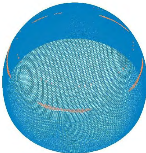
Σχήμα 3.11 Ράβδοι που έχουν αστοχήσει μέχρι το 1 ο βήμα (με πορτοκαλί)
