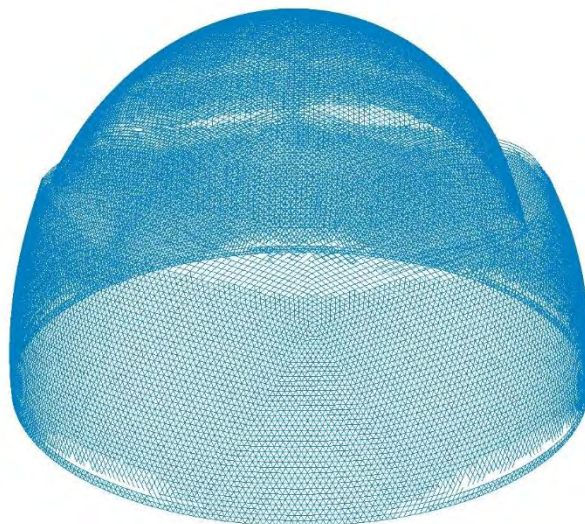
Σχήμα 3.43 Τελική μορφή κατάρρευσης του γεωδαιτικού θόλου, σύμφωνα με τη 2 η μέθοδο αναλύσεων
