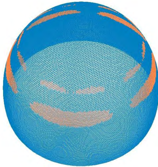
Σχήμα 3.34 Ράβδοι που έχουν αστοχήσει μέχρι το 6 ο βήμα (με πορτοκαλί)
