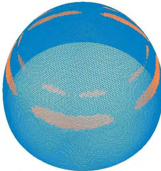
Σχήμα 3.33 Ράβδοι που έχουν αστοχήσει μέχρι το 5 ο βήμα (με πορτοκαλί)
