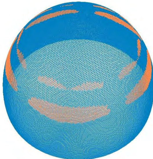
Σχήμα 3.35 Ράβδοι που έχουν αστοχήσει μέχρι το 7 ο βήμα (με πορτοκαλί)
