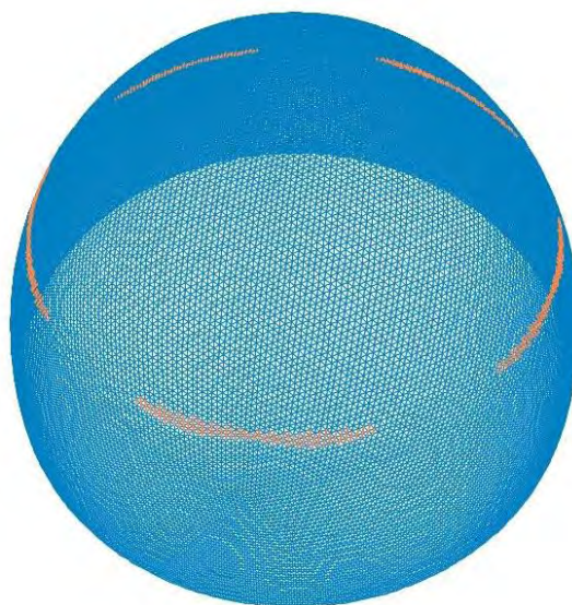
Σχήμα 3.29 Ράβδοι που έχουν αστοχήσει μέχρι το 1 ο βήμα (με πορτοκαλί)
