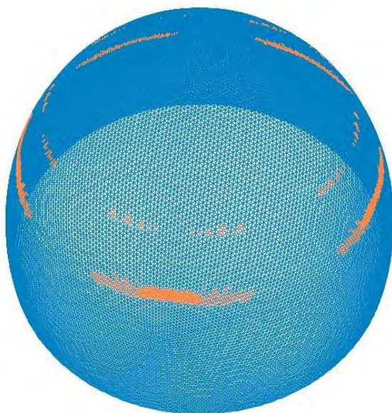
Σχήμα 3.12 Ράβδοι που έχουν αστοχήσει μέχρι το 2 ο βήμα (με πορτοκαλί)
