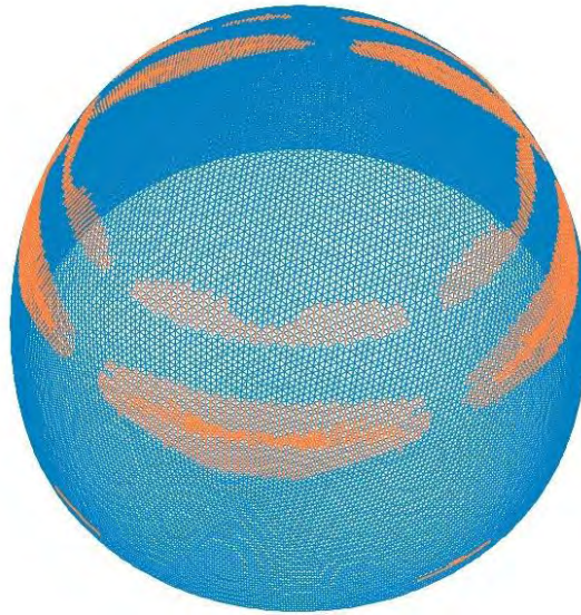
Σχήμα 3.38 Ράβδοι που έχουν αστοχήσει μέχρι το 10° βήμα (με πορτοκαλί)
