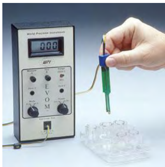
Εικόνα 27. Η διάταξη EVOMX με την οποία μετρούνταν η αντίσταση των μεσοθηλιακών κυττάρων απευθείας από την καλλιέργεια.
