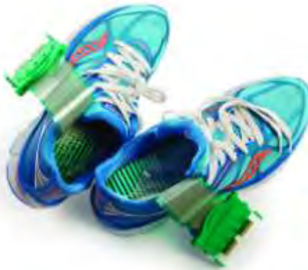
Εικόνα 6. Τοποθέτηση αισθητήρων συστήματος Fscan μέσα στο παπούτσι
