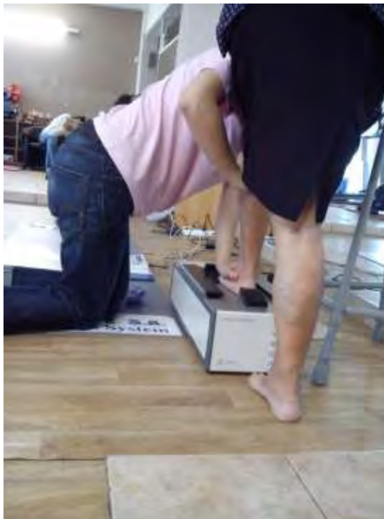
Εικόνα 7. Καταγραφή μορφολογίας πέλματος με Amfit
