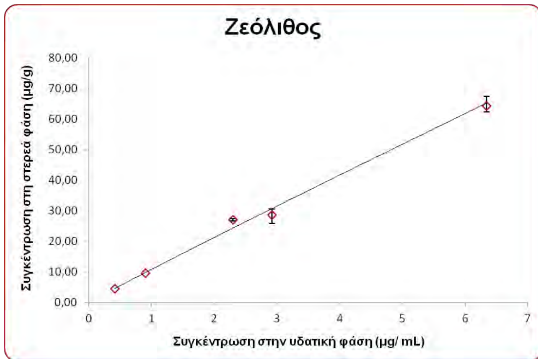
Γράφημα 13. Ισόθερμη προσρόφησης του linuron στο εδαφικό μίγμα που περιείχε ζεόλιθο σε ποσοστό 10% (w/w).
