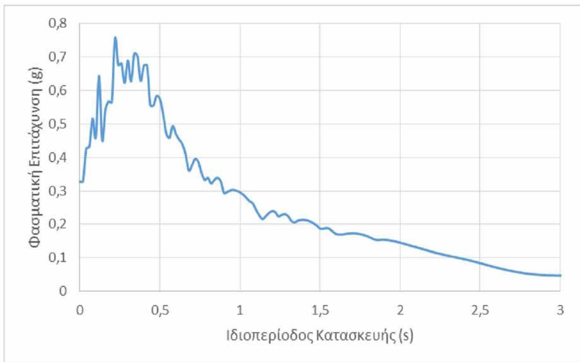
Σχήμα 3.26: Τροποποιημένη διέγερση Λευκάδας: Διάγραμμα φασματικής επιτάχυνσης σε σχέση με ιδιοπερίοδο κατασκευής.
