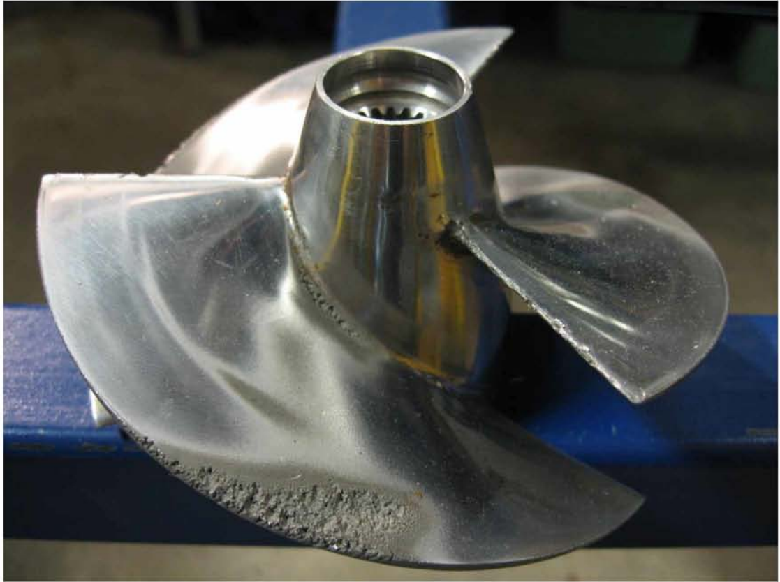
Εικόνα 3.10: Φαινόμενο σπηλαιώσης σε προπέλα
