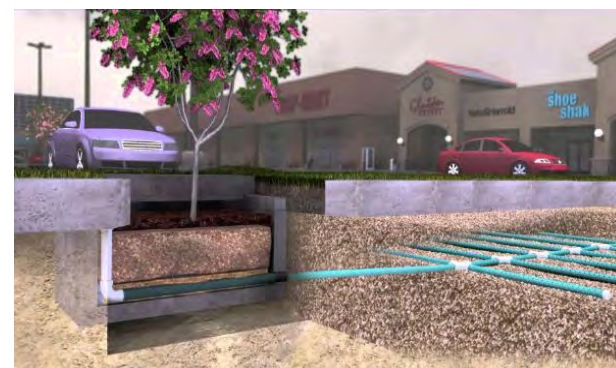
Εικ. 131: Δενδροδόχος βιοκατακράτησης Πηγή: http://www.engineeringnaturesway.co.uk/blog/blog-techniques-and-advice/bioretention-learning-from-the-us-experience/
