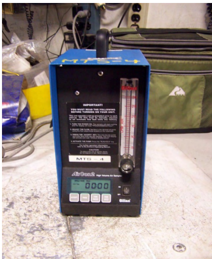
Εικόνα 11. Αντλία αναρρόφησης αέρα Gilian AirCon 2 της εταιρείας Sensidyne με κατακόρυφο επιλογέα - ταξινομητή τύπου Lumsden-Lynch.
