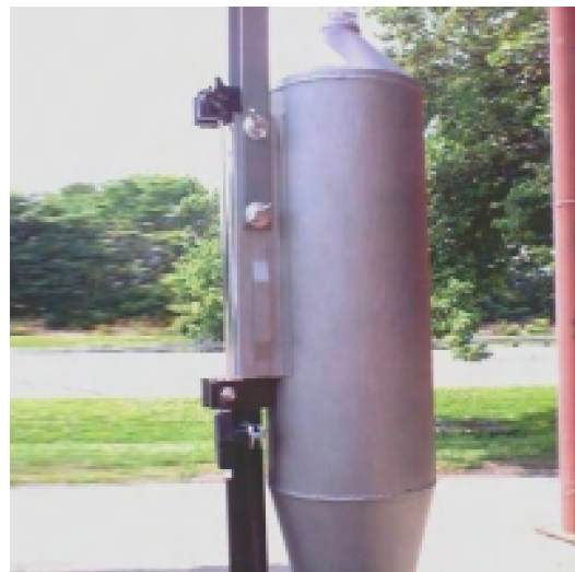
Εικόνα 11. Αντλία αναρρόφησης αέρα Gilian AirCon 2 της εταιρείας Sensidyne με κατακόρυφο επιλογέα - ταξινομητή τύπου Lumsden-Lynch.
