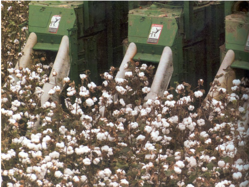
Εικόνα 2. Συγκομιδή βαμβακιού με βαμβακοσυλλεκτική μηχανή
