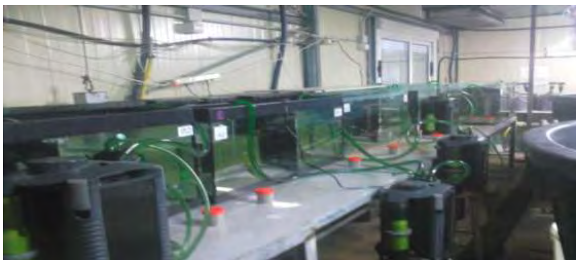
Εικόνα 2.2: Διάταξη δεξαμενών και απεικόνιση του κλειστού συστήματος κυκλοφορίας νερού (φωτογραφία συγγραφέων).
