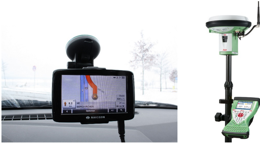
Εικόνα 8 - Πλοηγός χαμηλής ακρίβειας και δέκτης GPS υψηλής ακρίβειας (πηγές: http://en.wikipedia.org/wiki/Automotive_navigation_system http://www.leica-geosystems.com/en/Products_885.htm )
