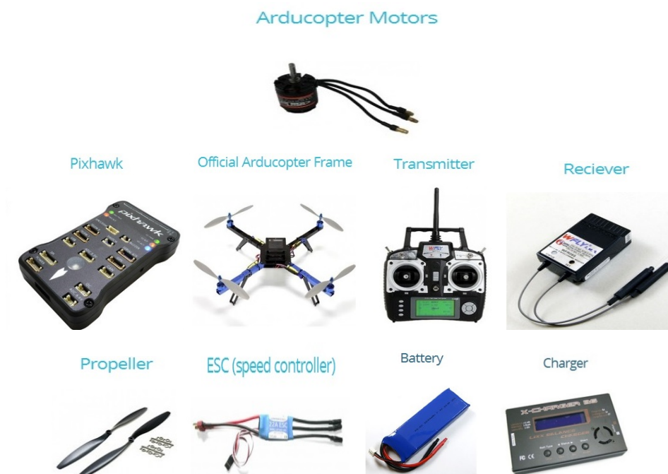
Εικόνα 35 – Μέρη του UAV ARIS Quadcopter (πηγή: http://www.arducopter.co.uk )
