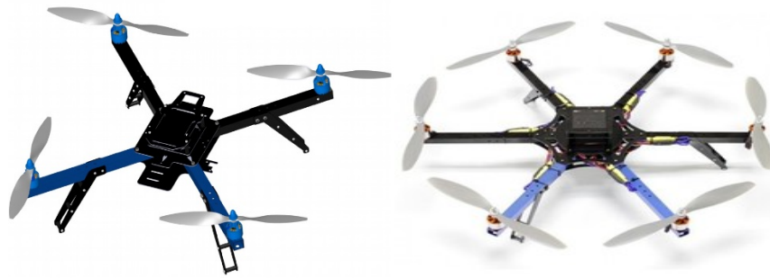
Εικόνα 11 – Ενδεικτικά είδη UAV με περιστρεφόμενα πτερύγια (πηγή: http://www.arducopter.co.uk/all-arducopter-guides )
