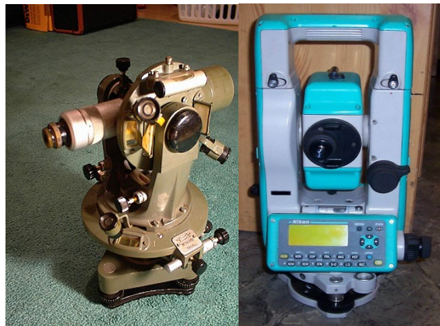
Εικόνα 5 – Παλιό θεοδόλιχο και σύγχρονο Total Station (πηγή: http://en.wikipedia.org/wiki/Theodolite )
