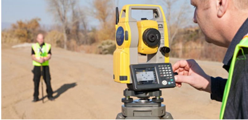
Εικόνα 7 – Ταχυμετρική αποτύπωση στο πεδίο (πηγή: http://www.goengineeringasia.com/ )
