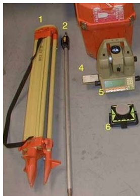
Εικόνα 6 – Απαραίτητος εξοπλισμός για την αποτύπωση (πηγή: http://activetectonics.asu.edu/TotalStation/checklist.html )
