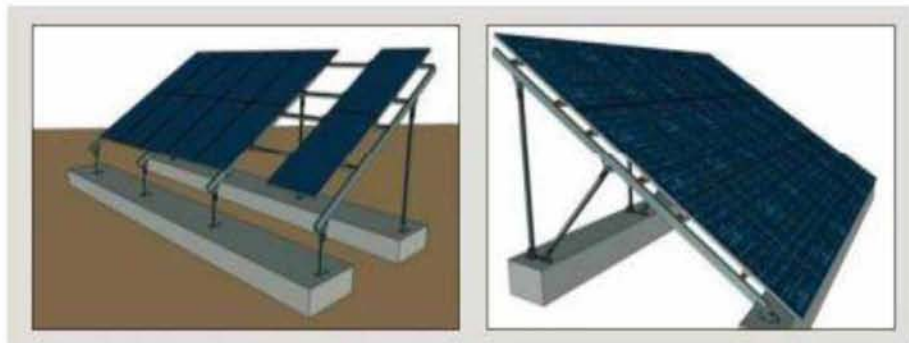
Εικόνα 3.1. Σκυροδέτηση σταθερών βάσεων σε δοκάρι από μπετόν
