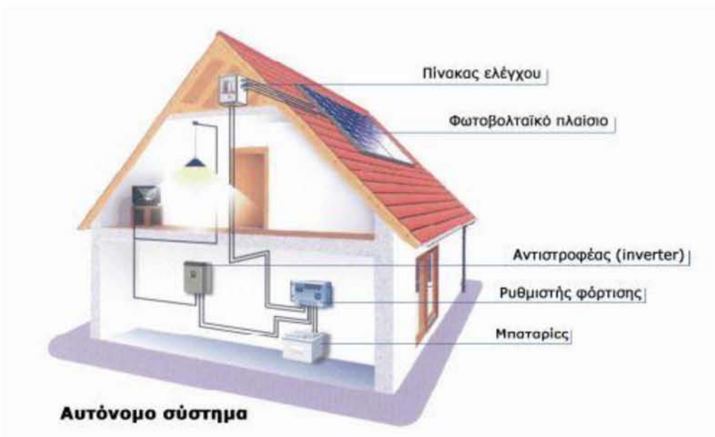
Εικόνα 2.2. Αυτόνομο φωτοβολταϊκό σύστημα
