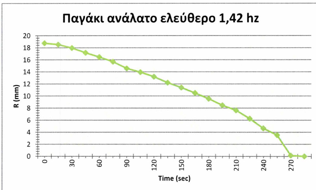
Διάγραμμα 5.4- Ανάλατο δοκίμιο πάγου σε 1,42 hz
