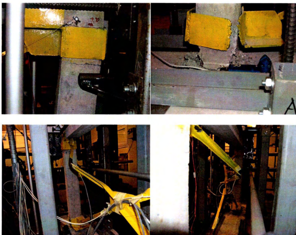
Εικόνα 3.6: Βλάβες στο πλαίσιο από Ο/Σ και τους Χ-συνδέσμους μετά το τέλος του 32 ου κύκλου φόρτισης.
