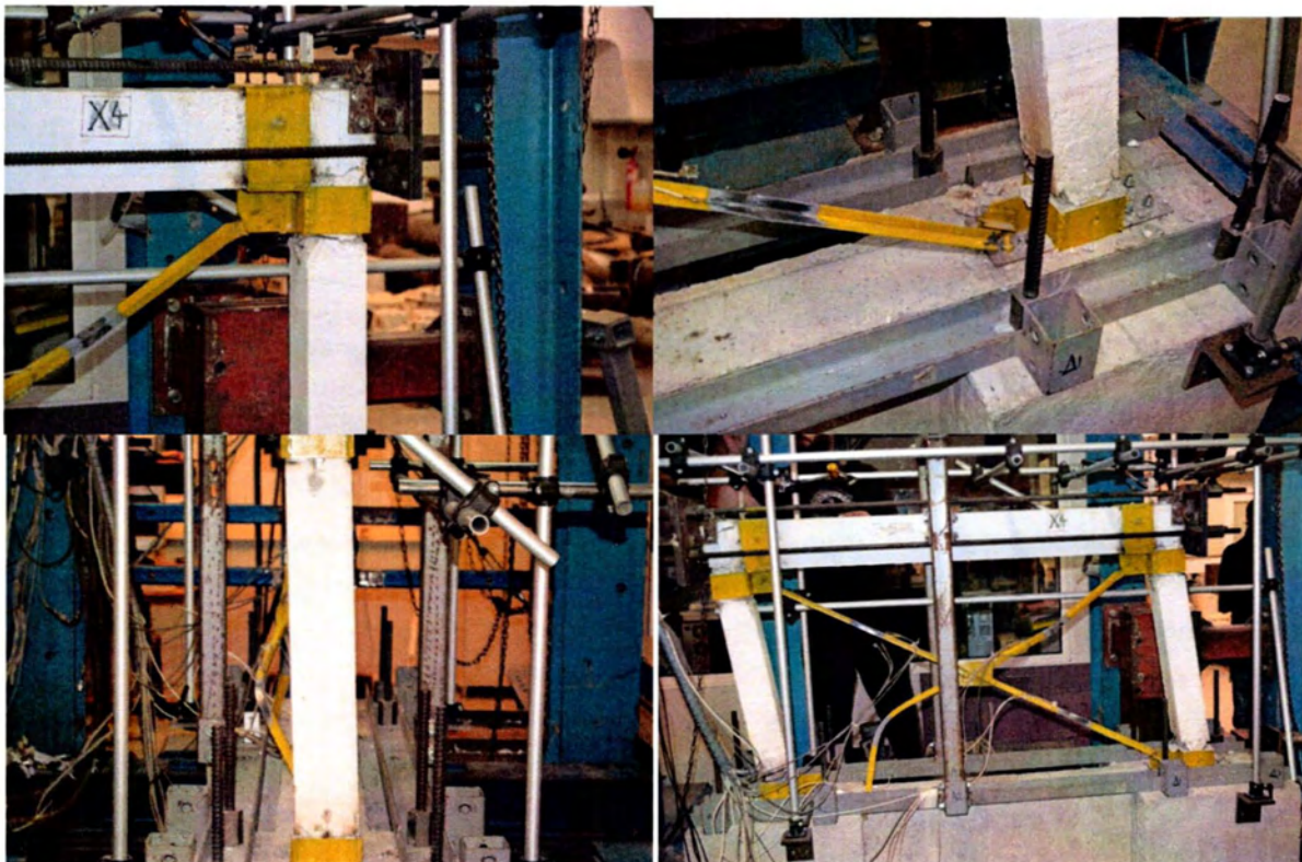
Εικόνα 3.9: Κατάσταση πλαισίου στον τερματισμό του πειράματος.
