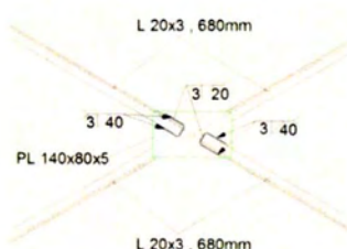
(γ) Λεπτομέρεια σύνδεσης κεντρικού κομβοελάσματος
