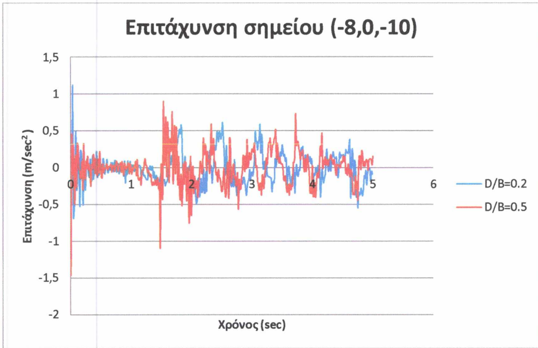
Σχ.4.21: Επιτάχυνση σημείου -8,0,-10 για λόγους έμπτυξης \frac{D}{B} = 0.2 , \frac{D}{B} = 0.5 υπό σεισμική διέγερση.
