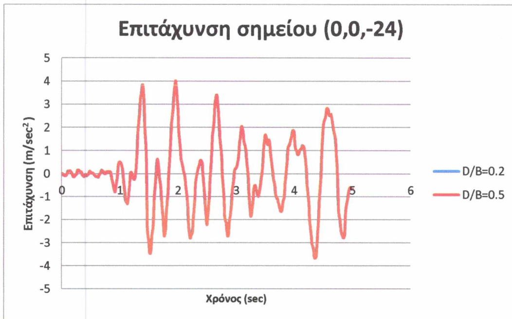
Σχ.4.23: Επιτάχυνση σημείου 0,0,-24 για λόγους έμπηξης \frac{D}{B} = 0.2 , \frac{D}{B} = 0.5 υπό σεισμική διέγερση.
