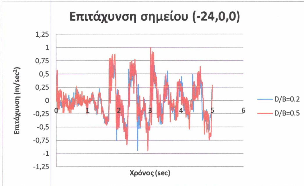
Σχ.4.19: Επιτάχυνση σημείου -24,0,0 για λόγους έμπτυξης \frac{D}{B} = 0.2 , \frac{D}{B} = 0.5 υπό σεισμική διέγερση.
