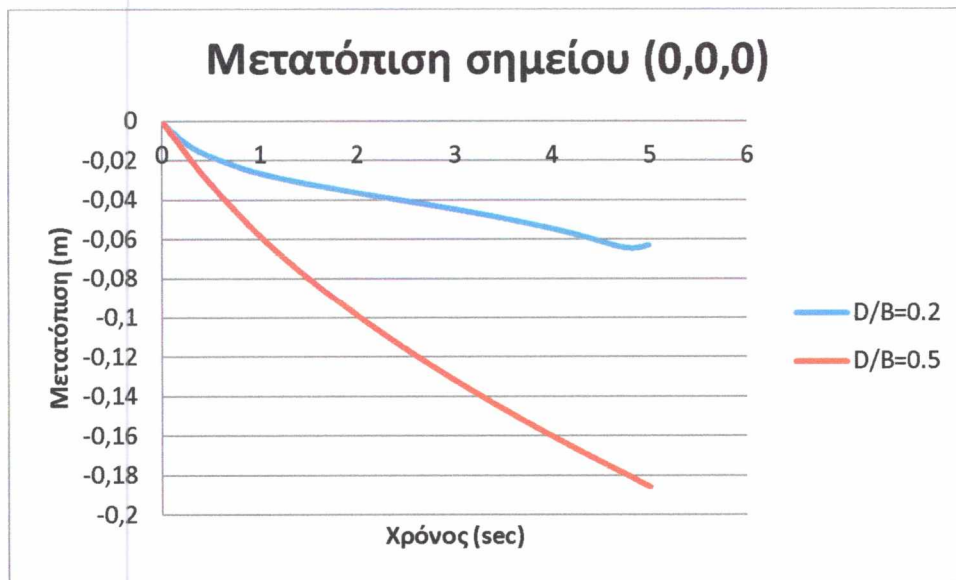
Σχ.4.27: Μετατόπιση σημείου 0,0,0 για λόγους έμπηξης \frac{D}{B} = 0.2 , \frac{D}{B} = 0.5 υπό ανεμική-κυματική διέγερση.
