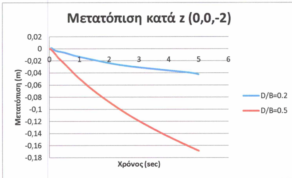
Σχ.4.29: Μετατόπιση σημείου 0,0,-2 για λόγους έμπηξης \frac{D}{B} = 0.2 , \frac{D}{B} = 0.5 υπό ανεμική-κυματική διέγερση.
