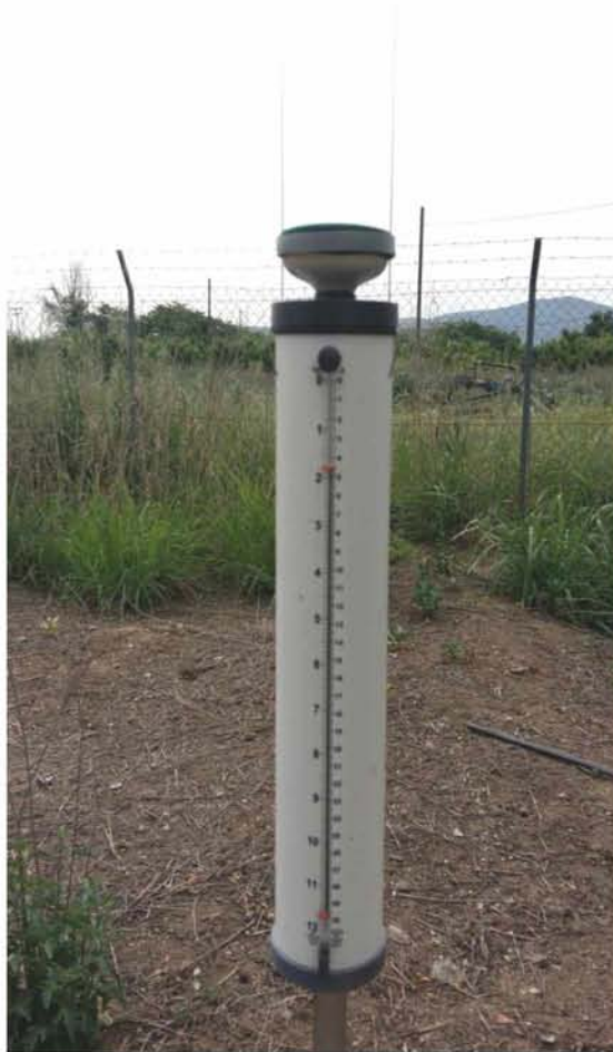
Εικόνα 7: Ατμόμετρο που υπολογίζει τη εξατμισοδιαπνοή τοποθετημένο στο αγρό.
