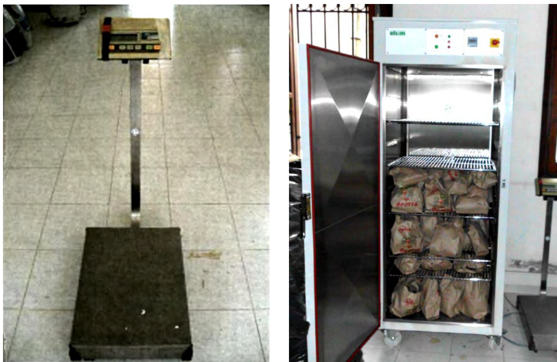
Εικόνα 5.14 και 5.15. Ο ζυγός ακριβείας και το πυριαντήριο.
