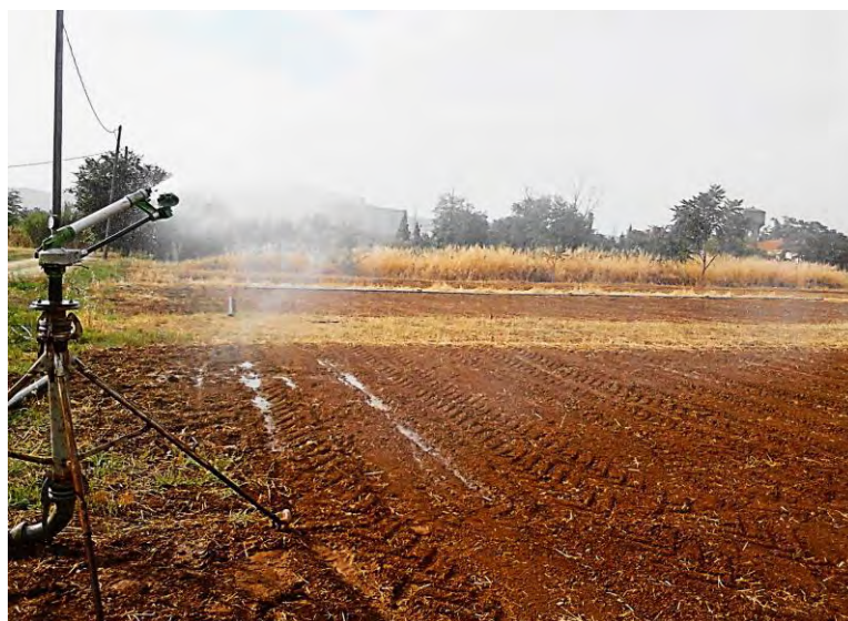
Εικόνα 5.5. Ο υψηλής πίεσης περιστρεφόμενος καταιονιστήρας.
