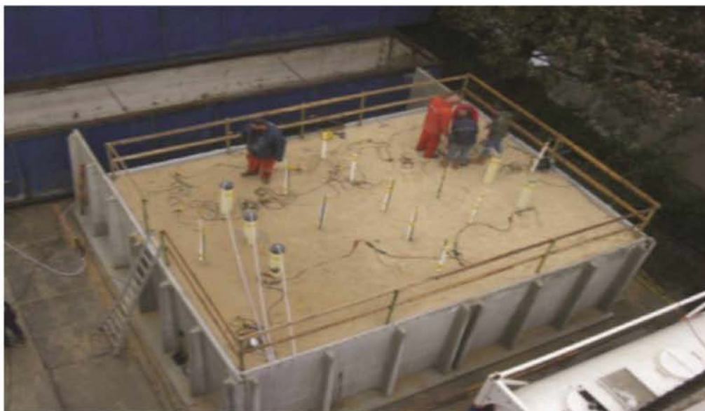
Σχήμα 4.51 Πειραματική διάταξη βιοενεμάτωσης μεγάλης κλίμακας ( 100\text{m}^3 ). Στο δεξί τμήμα του κιβωτίου άμμου βρίσκονται τα 3 φρεάτια έγχυσης ενώ στο αριστερό τα 3 φρεάτια εκχέλισης (Van Paassen, 2009).
