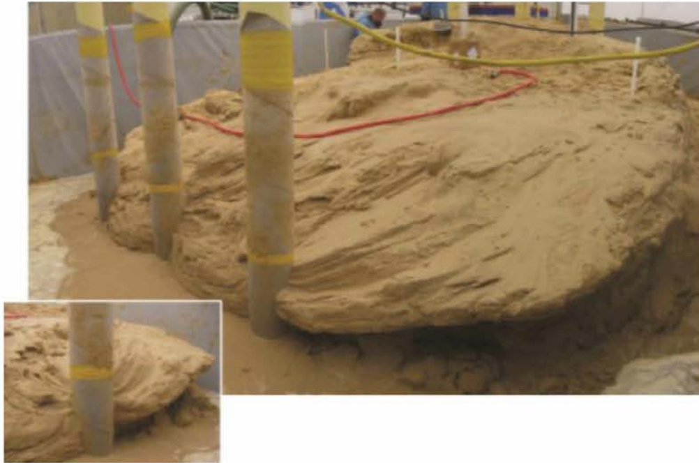
Σχήμα 4.53 Το τσιμεντοποιημένο σώμα άμμου των 100m 3 (Van Paassen, 2009).
