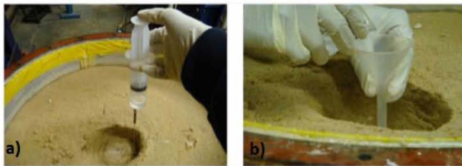
Σχήμα 4.73 Μέθοδος επισκευής της στήλης με a) ένεση και b) χοάνη (Duraismy, 2016).
