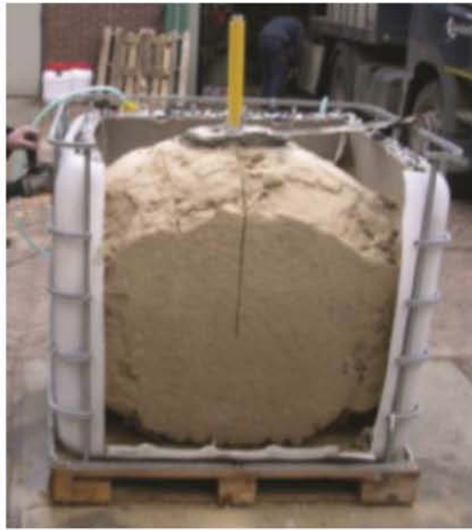
Σχήμα 4.52 Το σφαιρικό σχήμα του τσιμεντοποιημένου σώματος άμμου 1m 3 (Van Paassen, 2009).
