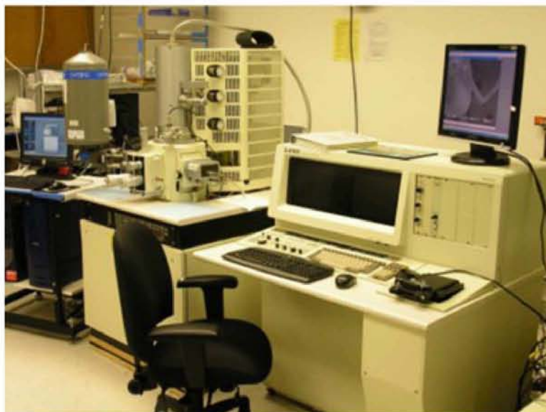
Σχήμα 3.3 Ηλεκτρονικό μικροσκόπιο σάρωσης (Alvarado).
