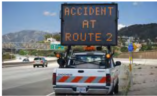
Εικόνα 45 PCMS σε φορητό για ειδοποίηση ατυχήματος
