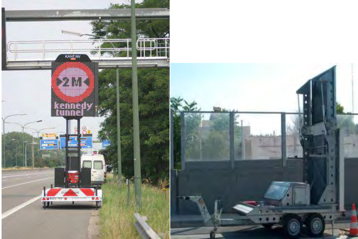
Εικόνα 46 Εικόνες τρέιλερ με υπερκατασκευή για τοποθέτηση οθονών τύπου LED σε 2 όψεις
