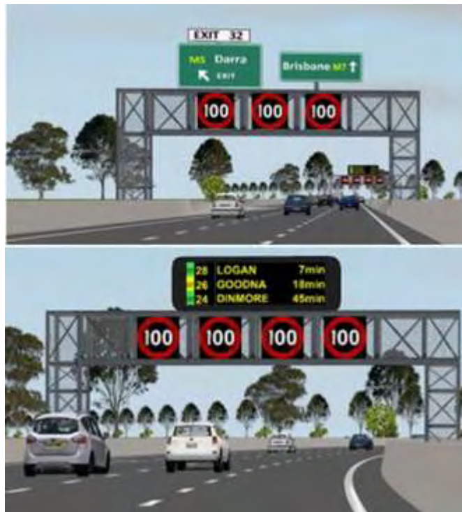
Εικόνα 12 Διπλή συστέγαση σημάτων κατεύθυνσης και VSL / LCS./ Διπλή συστέγαση VMS και VSL / LCS.
