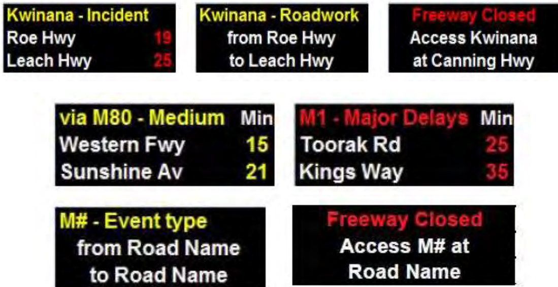
Εικόνα 26 RC3-VMS για μηνύματα σε πραγματικό χρόνο ατυχημάτων /εργασιών /κλεισίματος δρόμου/πληροφορίες διαδρομής σε πραγματικό χρόνο
