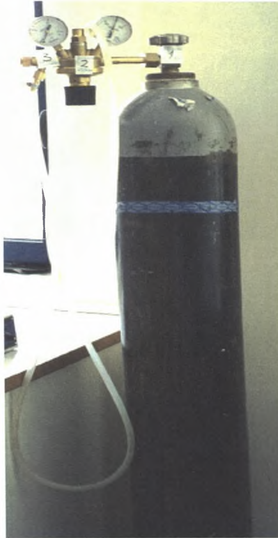
Εικόνα 2.1. Φιάλη αερίου περιεκτικότητας 70% σε N_2 και 30% σε CO_2 .
