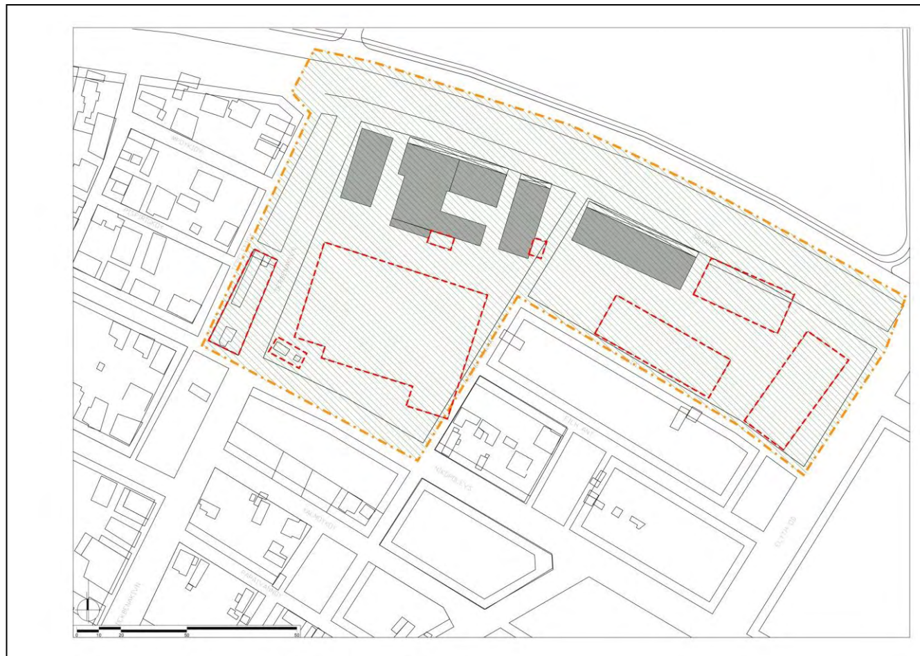
Εικόνα 80 : κτίσματα προς απομάκρυνση
