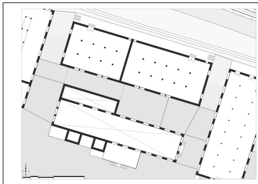
Εικόνα 61 : αποτύπωση λιθόκτιστων κτιρίων αρ. 8 & 9 (όροφος)
