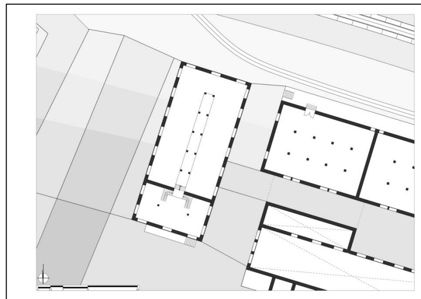
Εικόνα 54 : αποτύπωση λιθόκτιστου κτιρίου αρ.7 (όροφος)
