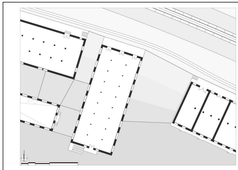
Εικόνα 71 : αποτύπωση λιθόκτιστου κτιρίου αρ. 10 (όροφος)
