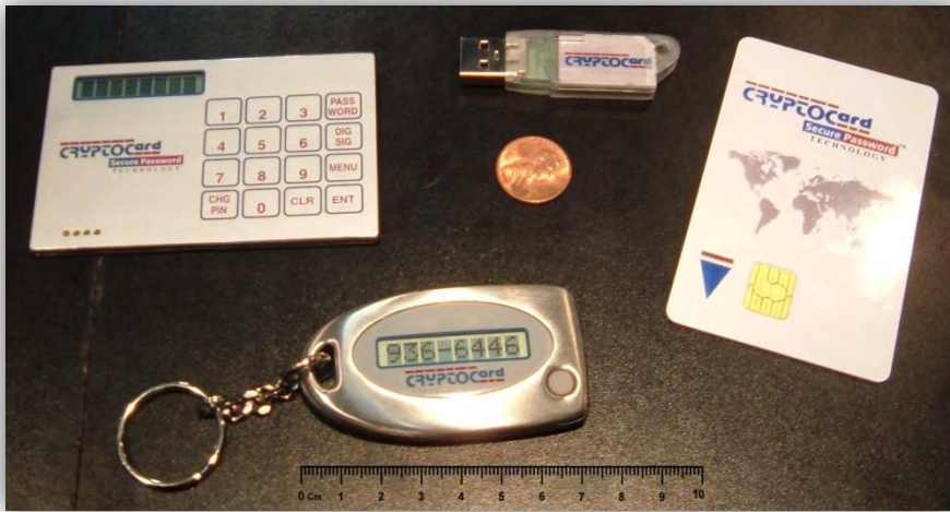
Εικόνα 1.2 - Στη φωτογραφία εικονίζονται οι συσκευές παραγωγής εξωτερικών κωδικών ασφαλείας (safe code generators) (πάνω αριστερά και κάτω στο κέντρο), η μονάδα ασφαλούς πιστοποίησης USB (πάνω, κέντρο) και η έξυπνη κάρτα (πάνω δεξιά).
