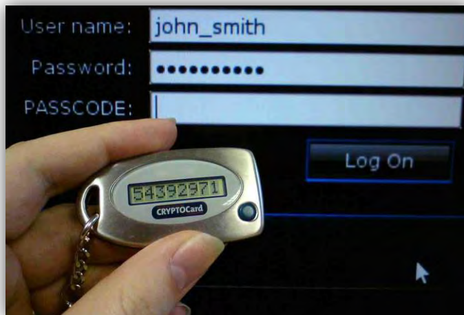
Εικόνα 1.3 - Παράθυρο πρόσβασης ενός Διαχειριστή Κλειδαρίθμων ο οποίος υποστηρίζει πρόσβαση με «πολλαπλά κριτήρια πιστοποίησης». Στον συγκεκριμένο Διαχειριστή χρησιμοποιείται εξωτερικός κωδικός ασφαλείας (security token), επιπλέον του κύριου κωδικού πρόσβασης και του ονόματος χρήστη.
