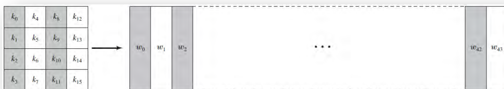
Εικόνα 3.2 - Ο πίνακας w που προκύπτει μετά την διαδικασία Επέκτασης Κλειδιού του Rijndael, για κλειδί κρυπτογράφησης αρχικού μεγέθους 128 bits. Τα k_0 έως k_{15} και τα w_0 έως w_{43} αποτελούν λέξεις των 4 bytes η κάθε μία.
