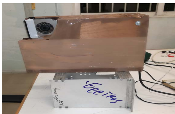
Εικόνα 4.1 Αριστερά: Οριζόντιος προσανατολισμός ( Horizontal position ) & Δεξιά: Κατακόρυφος προσανατολισμός ( Vertical position ) της πειραματικής διάταξης
