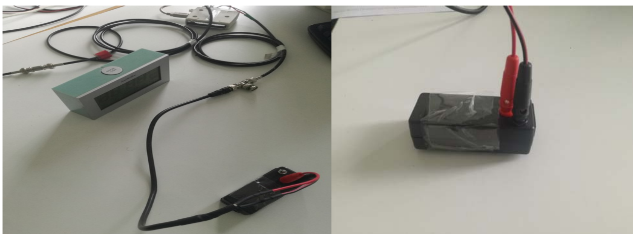
Εικόνα 3.15 Η συσκευή μετατροπής σημάτων- προσομοίωσης των σεναρίων θέρμανσης και ψύξης του πυρήνα από χαλκό και το χρονόμετρο
