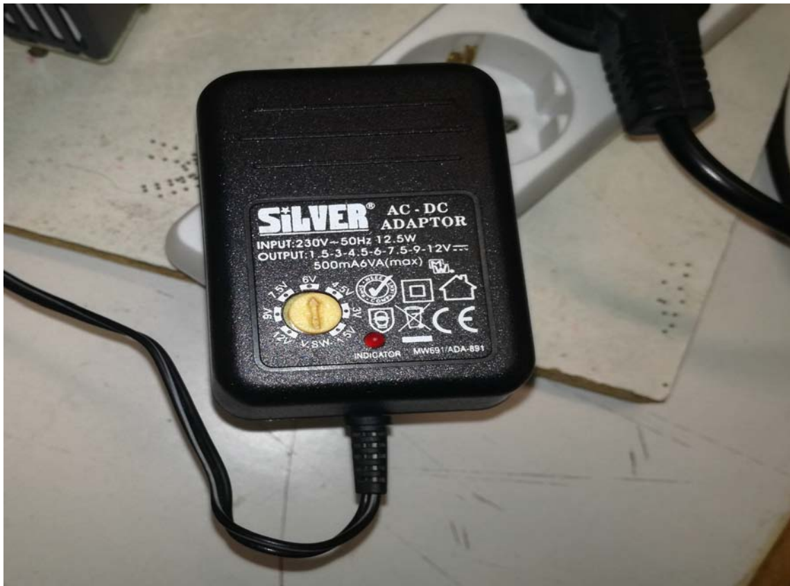
Εικόνα 4.3 Ο μετασχηματιστής-ανορθωτής τάσης του fan (ανεμιστήρα)
