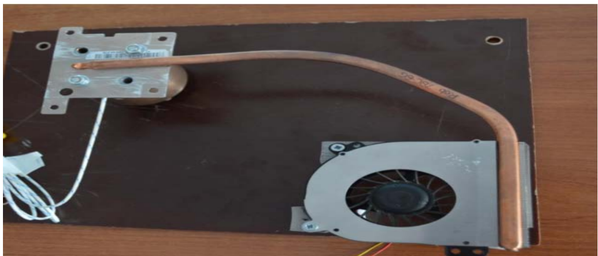
Εικόνα 3.8 Στο κάτω δεξί τμήμα της διάταξης η εγκατάσταση του ανεμιστήρα με ενσωματωμένο ηλεκτροκινητήρα [27]
