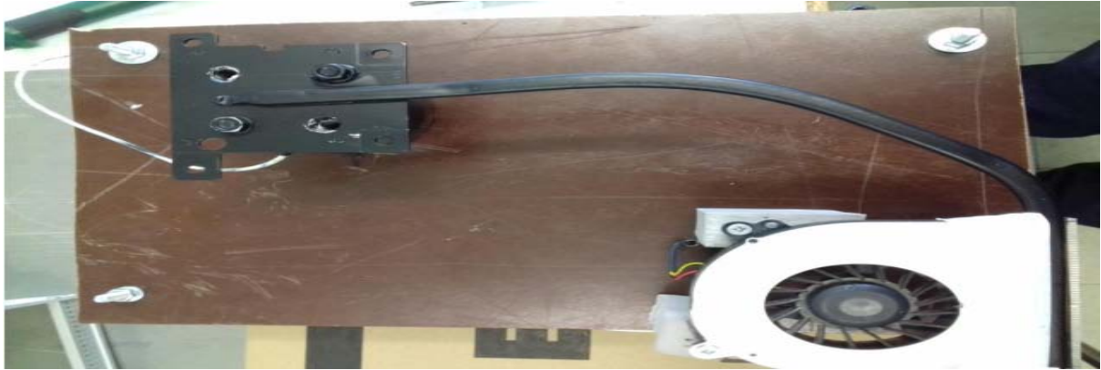
Εικόνα 3.9 Χρώση του αγωγού θερμότητας ( heat pipe ) σε μαύρο ματ χρώμα
