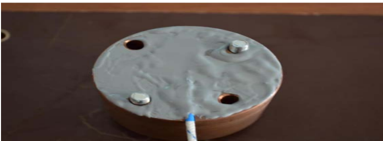
Εικόνα 3.4 Επάλειψη του πυρήνα χαλκού με τη θερμοαγώγιμη πάστα πριν τη συναρμολόγηση
