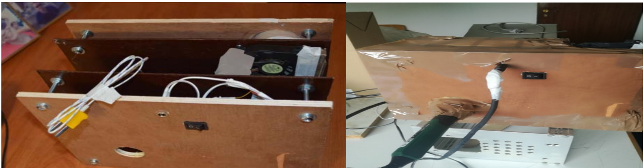
Εικόνα 3.11 Τοποθέτηση διακόπτη On/Off του ανεμιστήρα και ταχυσυνδέσμου για τη παροχή συνεχούς ισχύος
