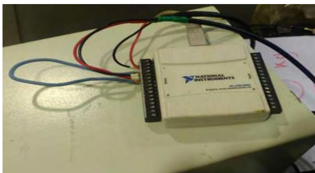
Εικόνα 3-11 Μετατροπέας σήματος από αναλογικό σε ψηφιακό της National Instruments.
