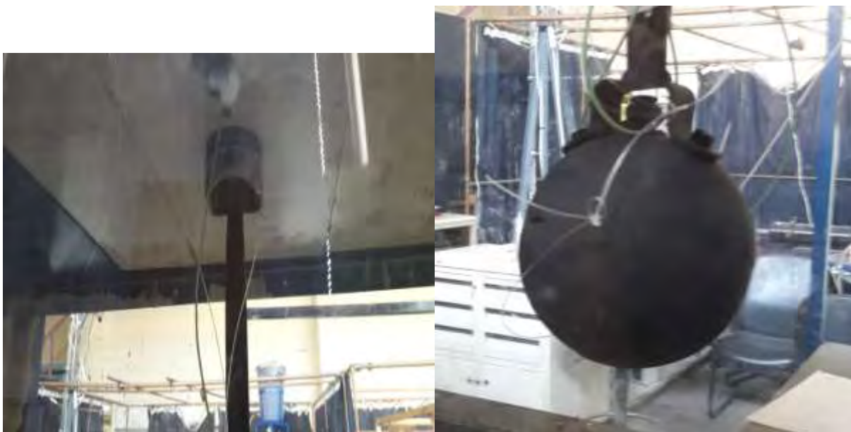
Εικόνα 3-6 Η κεφαλή του εμβόλου με την προέκταση μπιέλας (Αριστερά) και η σύνδεση της σφαίρας με την προέκταση μπιέλας (Δεξιά).
