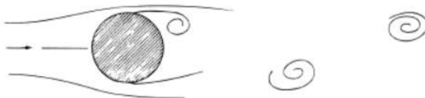
Εικόνα 2-3 Διαμόρφωση δινών πίσω από ένα κυλινδρικό σώμα.
