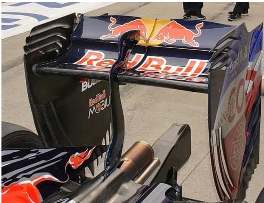
Εικόνα 2.13: Οπίσθια αεροτομή με endplates από μονοθέσιο τύπου Formula 1
