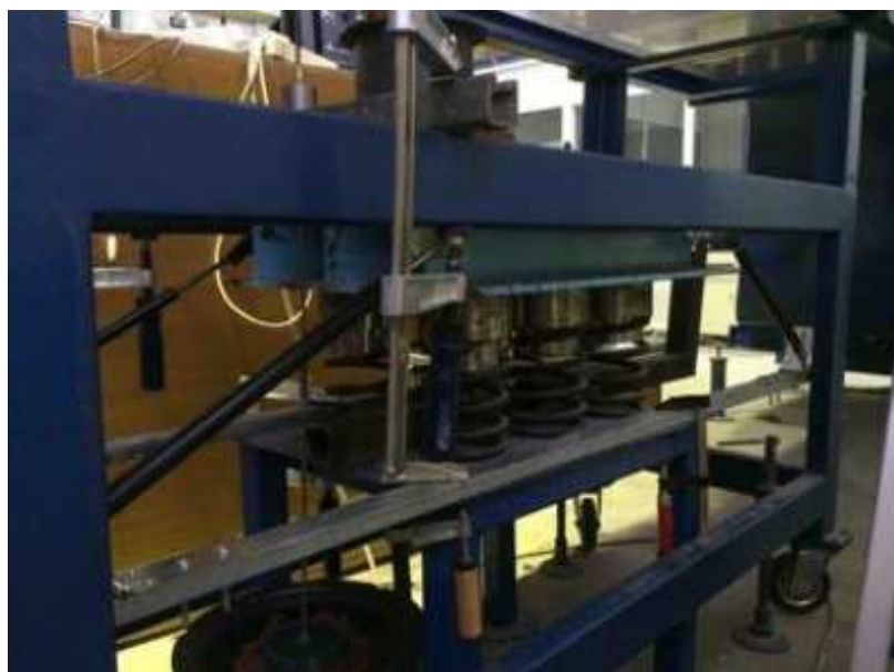
Εικόνα 3.3: Η αδρανειακή βάση της αεροσήραγγας
