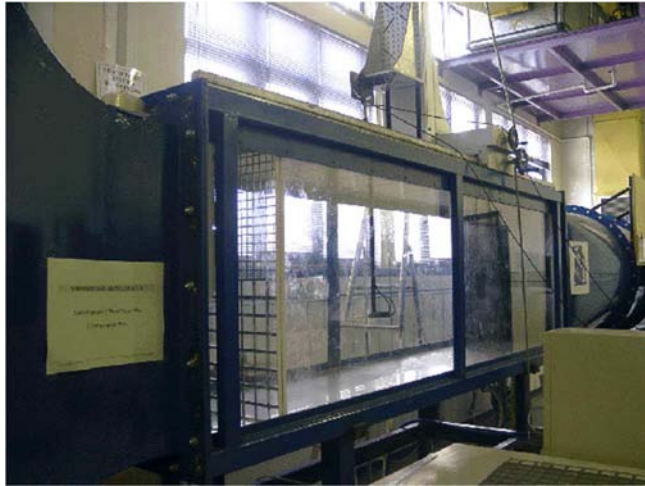
Εικόνα 3.1: Το τμήμα δοκιμών της αεροσήραγγας
