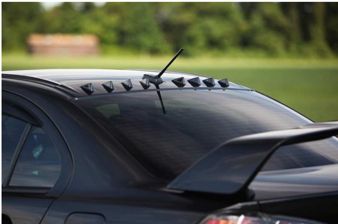
Εικόνα 2.8: Vortex Generators από Mitsubishi Evo X
