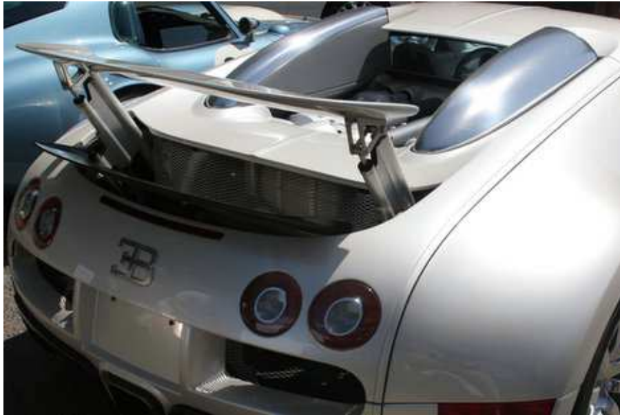
Εικόνα 2.14: Υδραυλικά κινούμενο spoiler από Bugatti Veyron
