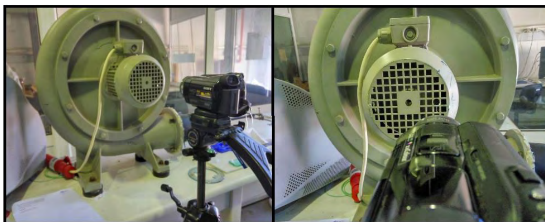
Εικόνα 3.20 : Βιντεοκάμερα υψηλής ακρίβειας Sony 50 fps.
