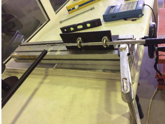
Σχήμα 3.13 Εμπρός όψη κατασκευής (διακρίνεται ο τρόπος συγκράτησης του αισθητήρα του μανομέτρου)
