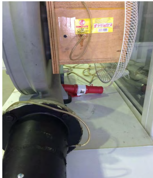
Σχήμα 3.8 Διάταξη σωλήνων μέτρησης διαφοράς πίεσης
