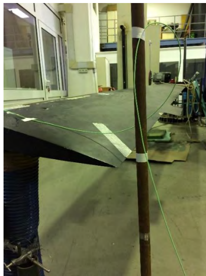
Σχήμα 3.26 Θέση ισορροπίας πτέρυγας (λευκή ταινία πάνω στη ράβδο)
