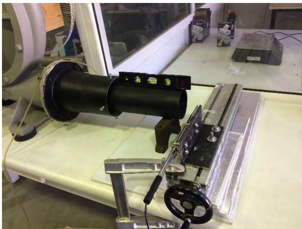
Σχήμα 3.16 Στήριξη δοκιμίων σε μετρήσεις ταχυτήτων ροής
