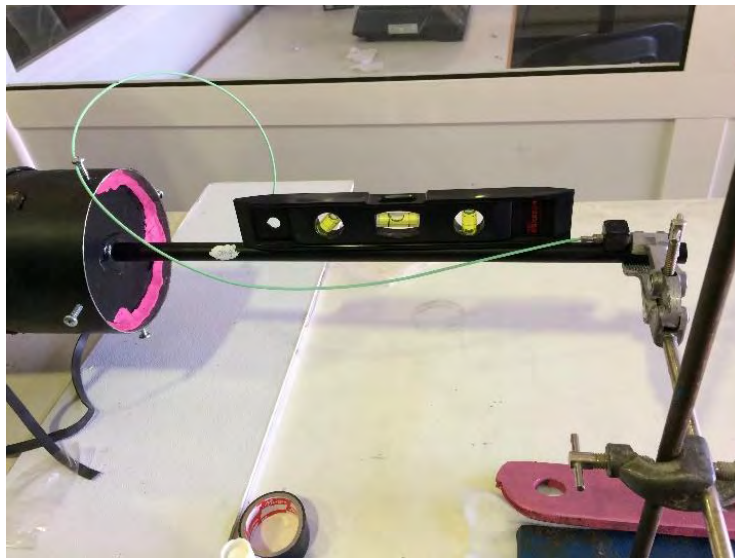
Σχήμα 3.23 Μέτρηση επιταχύνσεων στο πέρας του δοκιμίου (9)
