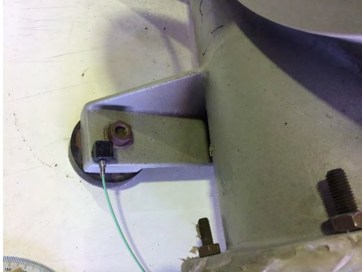
Σχήμα 3.22 Μέτρηση ταλαντωτικών σημάτων στη βάση του συμπιεστή
