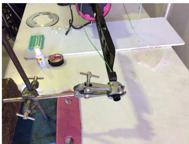
Σχήμα 3.17 Στήριξη δοκιμίων σε μετρήσεις ταλαντώσεων συμπιεστή
