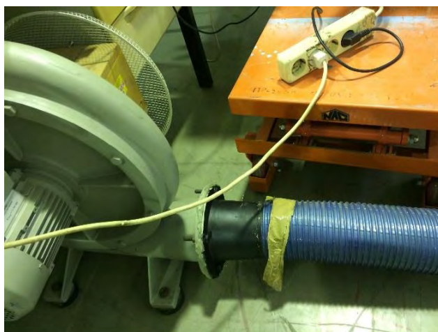
Σχήμα 3.18 Σύνδεση σωλήνα PVC με συμπιεστή
