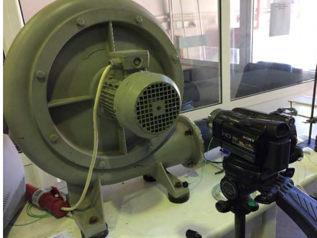
Σχήμα 3.24 Μέτρηση στροφών με κάμερα υψηλής ταχύτητας
