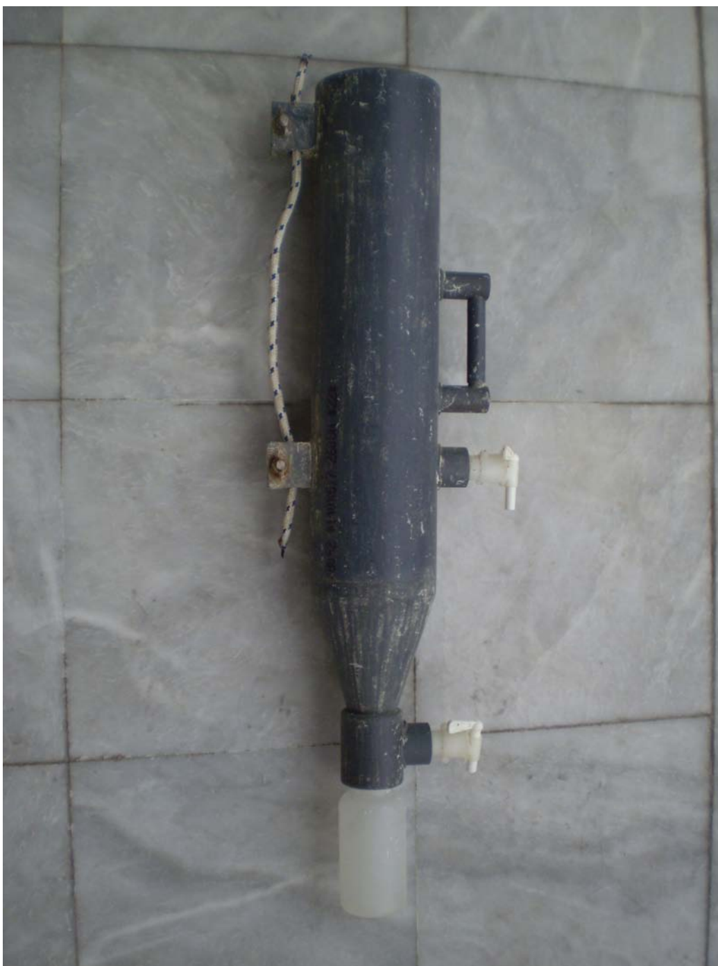
Εικόνα 4.5: Φωτογραφία της ιζηματοπαγίδας για τη συλλογή των υπολειμμάτων τροφής και των περιττωμάτων των εκτρεφόμενων ψαριών.
