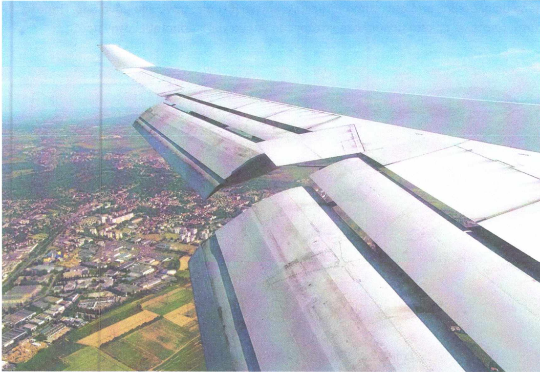
Σχήμα 7, Boeing 747 με τα triple-slotted flaps σε πλήρη έκταση
