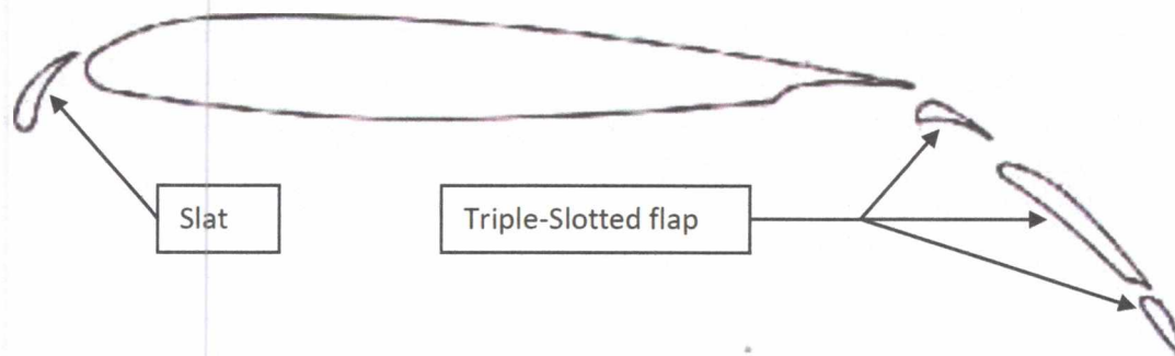
Σχήμα 2, τυπική υπεραντωτική διάταξη με slat και triple-slotted flap
