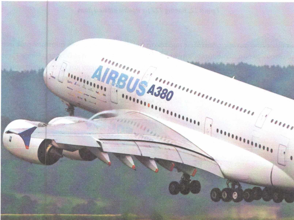
Σχήμα 11, Airbus A380 με single-slotted flaps σε πλήρη έκταση
