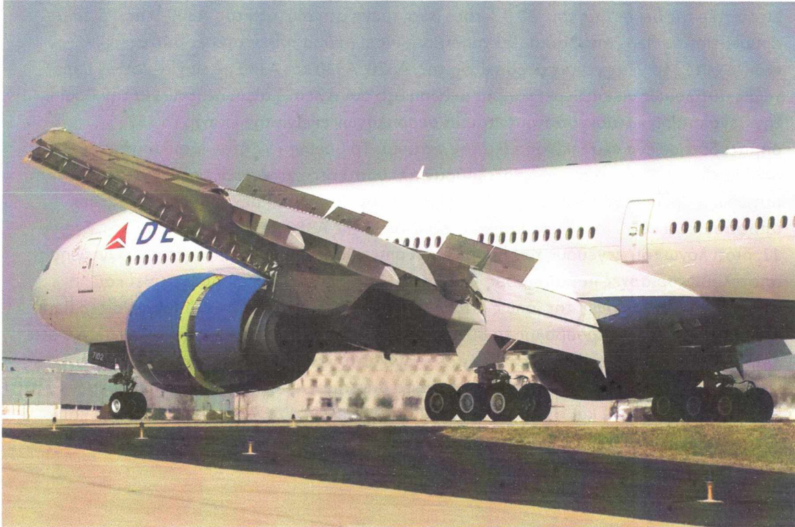
Σχήμα 12, Boeing 777 με double-slotted flaps
