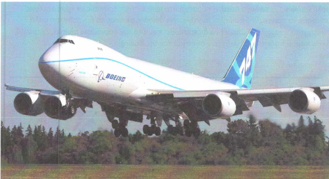
Σχήμα 8, Boeing 747 με ανοιγμένα τα Kruger flap
