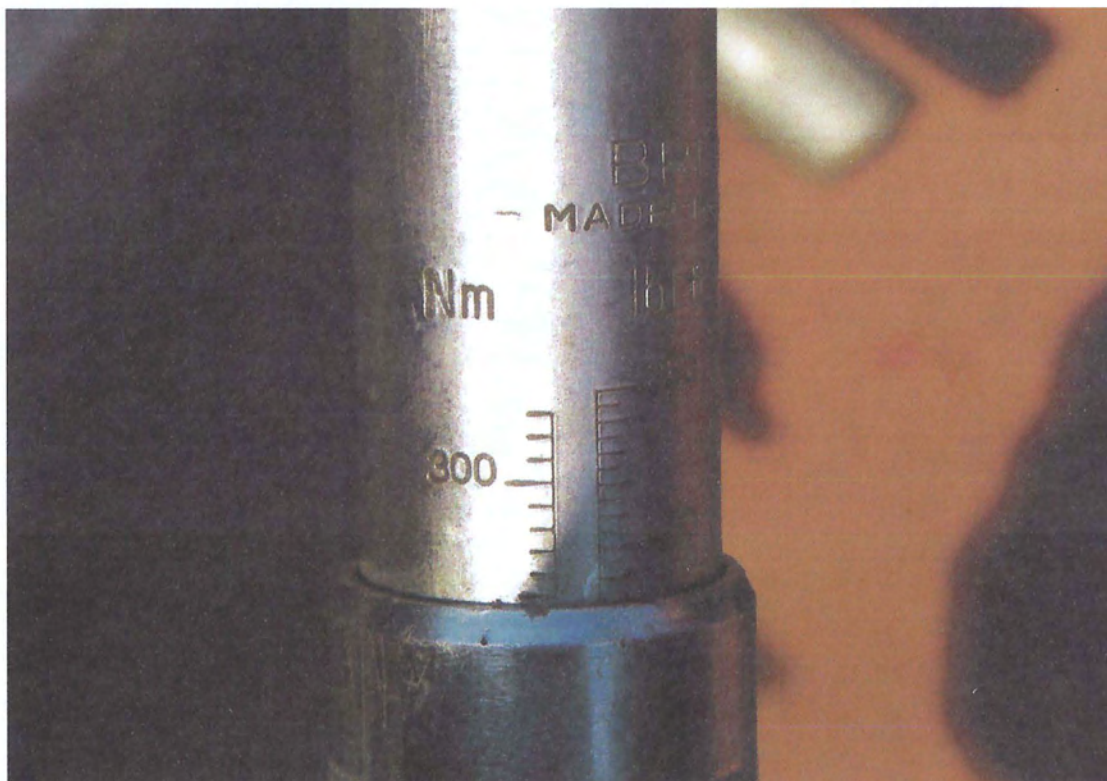
Εικόνα 1.12: Ρύθμιση δυναμόκλειδου με κόφτη ροπής
