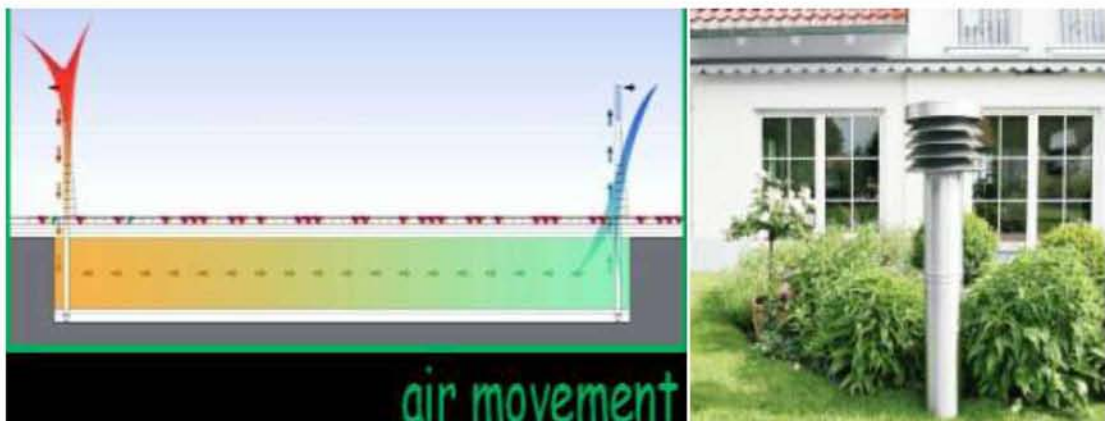
Εικόνα 10: Σύστημα εναλλάκτη θερμότητας αέρα-εδάφους
