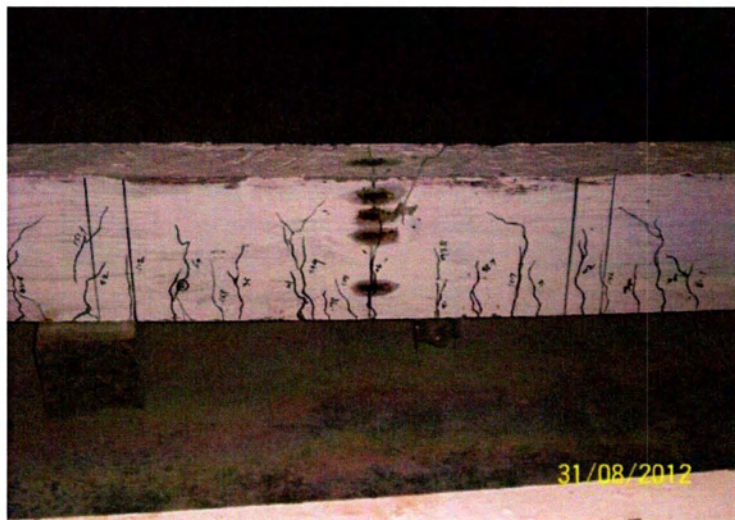
Εικόνα 9-1: Σχηματισμοί ρωγμών (Preetha R., Joanna P.S., Rooby J. και Pillai C.S., 2013).
