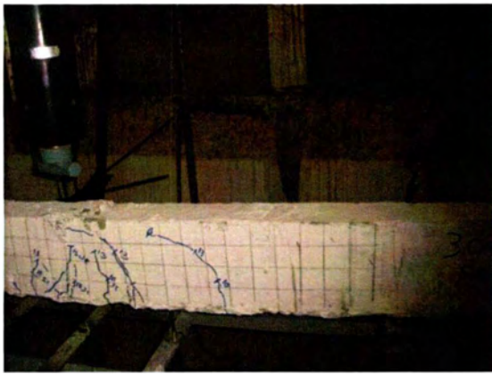
Εικόνες 9-3 α,β: Οι ρωγμές που δημιουργήθηκαν στις δοκούς με ι.τ. (Sunilaa G. και Dr. Thenmozhi R, 2011).
