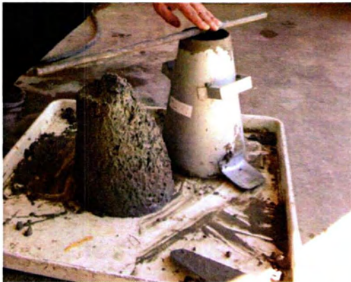
Εικόνες 10-5 α,β: Κάθιση σκυροδέματος με σκέτο τσιμέντο.
