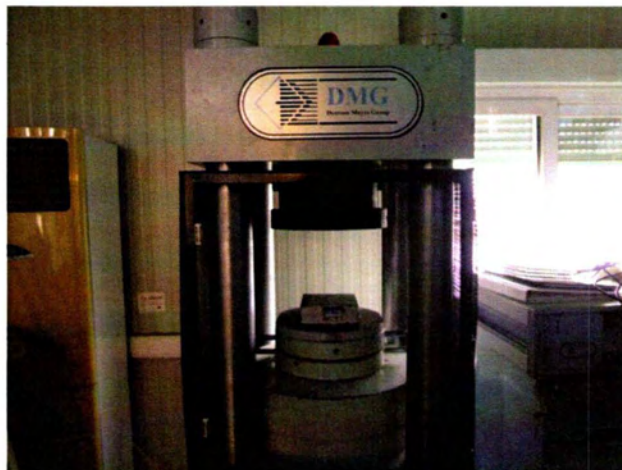
Εικόνα 10-15: Μηχανή DMG με διάταξη για δοκιμή κύβου σκυροδέματος σε θλίψη.
