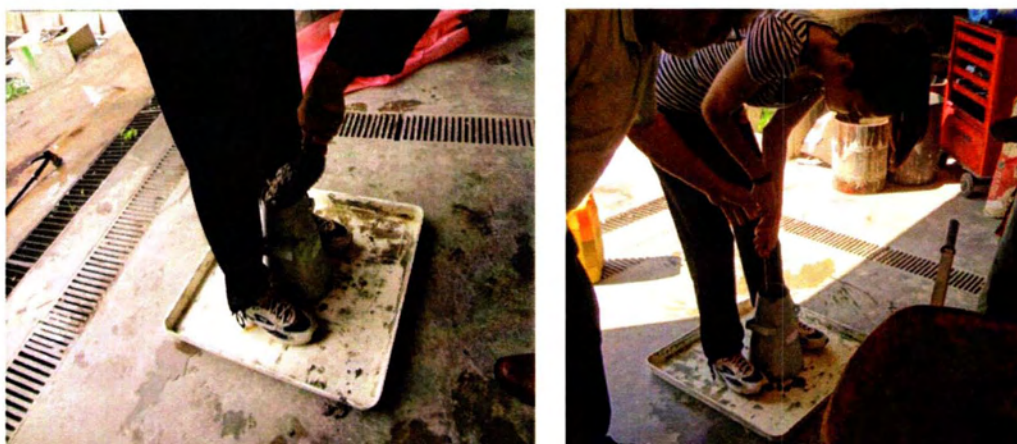
Εικόνες 10-3 α,β: Αριστερά φαίνεται το γέμισμα του κώνου με την σέσουλα και δεξιά η συμπύκνωση της πρώτης στρώσης με την ράβδο.
