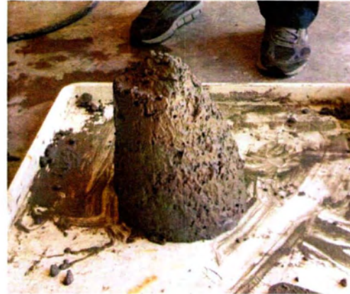
Εικόνες 10-5 α,β: Κάθιση σκυροδέματος με σκέτο τσιμέντο.
