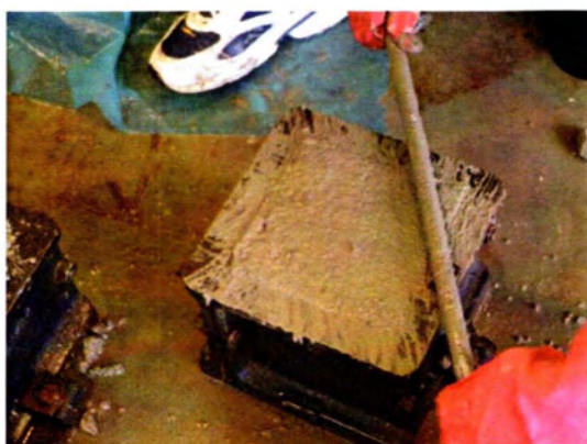
Εικόνες 10-10 α,β: Επιπέδωση της τελικής επιφάνειας αρχικά με την ράβδο και μετά με την σπάτουλα.
