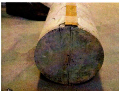
Εικόνες 10-22 α,β,γ: Ρηγμάτωση κατά την αστοχία δοκιμίων σκυροδέματος με 100% τσιμέντο.
