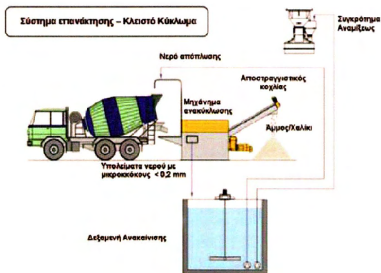
Εικόνα 7-5: Επανάκτηση υλικών από υπολείματα σκυροδέματος, κλειστό κύκλωμα (Εφραιμίδης, 2008).
