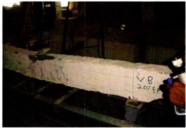
Εικόνες 9-3 α,β: Οι ρωγμές που δημιουργήθηκαν στις δοκούς με ι.τ. (Sunilaa G. και Dr. Thenmozhi R, 2011).
