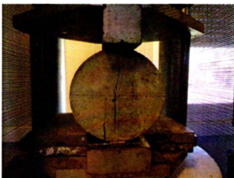
Εικόνες 10-23 α,β,γ: Ρηγμάτωση κατά την αστοχία δοκιμίων σκυροδέματος με 15% ι.τ..
