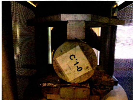
Εικόνα 10-21: Τοποθέτηση κυλινδρικού δοκιμίου σκυροδέματος στην μηχανή DMG για δοκιμή έμμεσου εφελκυσμού.
