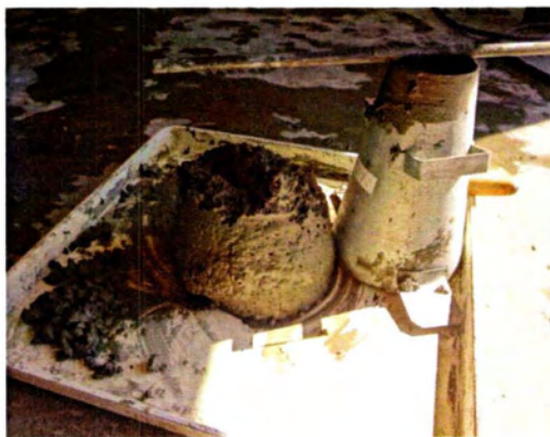
Εικόνες 10-6 α,β: Κάθιση σκυροδέματος με 15% ιπτάμενη τέφρα.
