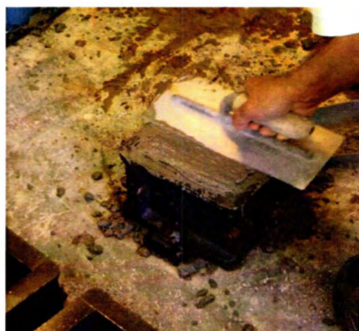
Εικόνες 10-10 α,β: Επιπέδωση της τελικής επιφάνειας αρχικά με την ράβδο και μετά με την σπάτουλα.
