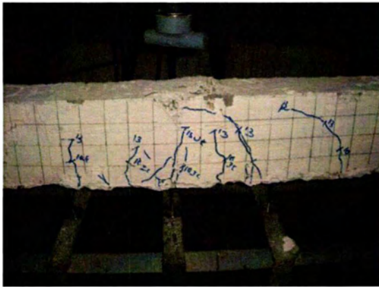
Εικόνα 9-4 α,β: Οι ρωγμές που δημιουργήθηκαν στις δοκούς με ε.ι.τ. (Sunilaa G. και Dr. Thenmozhi R, 2011).
