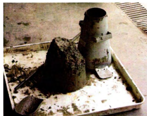
Εικόνες 10-7 α,β: Κάθιση σκυροδέματος με 30% ιπτάμενη τέφρα.
