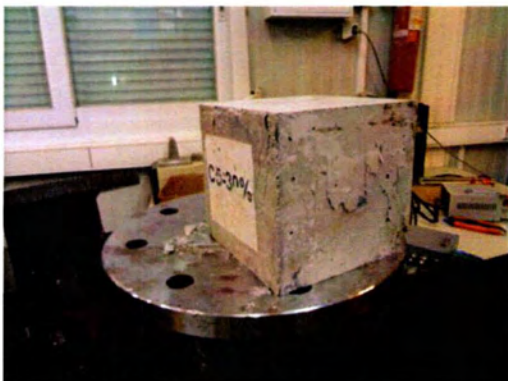
Εικόνες 10-19 α-στ: Θραύση δοκιμών σκυροδέματος με 30% ιπτάμενη τέφρα.
