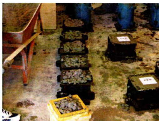
Εικόνες 10-8 α,β: Αριστερά φαίνεται το γέμισμα της πρώτης στρώσης και δεξιά το γέμισμα της δεύτερης στρώσης σκυροδέματος.
