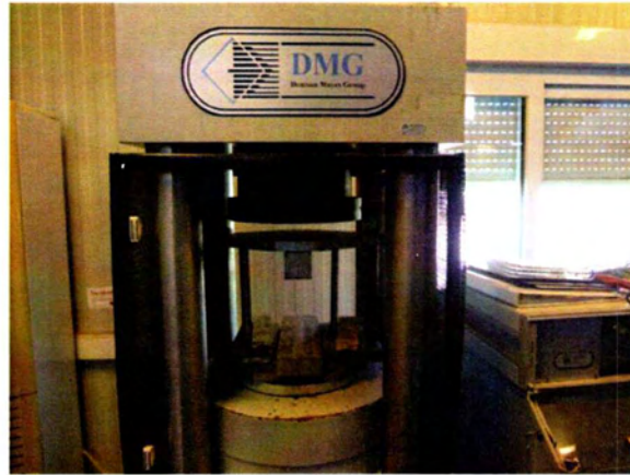
Εικόνα 10-20: Μηχανή DMG με διάταξη για δοκιμή κυλίνδρου σκυροδέματος σε έμμεσο εφελκυσμό.
