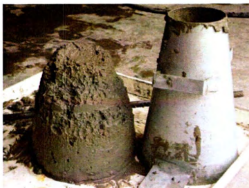
Εικόνες 10-7 α,β: Κάθιση σκυροδέματος με 30% ιπτάμενη τέφρα.
