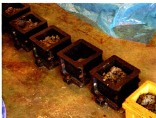
Εικόνες 10-8 α,β: Αριστερά φαίνεται το γέμισμα της πρώτης στρώσης και δεξιά το γέμισμα της δεύτερης στρώσης σκυροδέματος.
