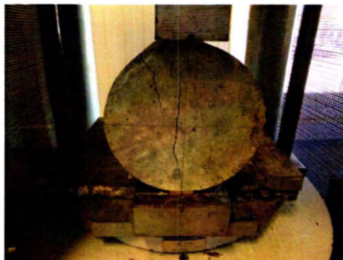
Εικόνες 10-22 α,β,γ: Ρηγμάτωση κατά την αστοχία δοκιμίων σκυροδέματος με 100% τσιμέντο.
