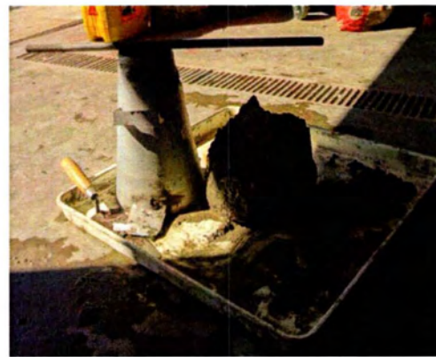
Εικόνες 10-6 α,β: Κάθιση σκυροδέματος με 15% ιπτάμενη τέφρα.
