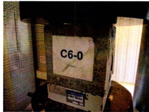
Εικόνες 10-17 α-στ: Θραύση δοκιμίων σκυροδέματος με 100% τσιμέντο.
