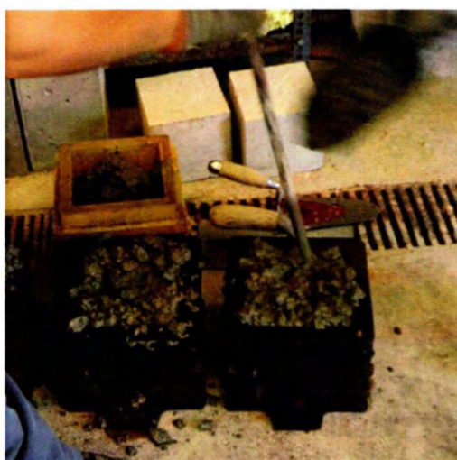
Εικόνα 10-9: Συμπύκνωση της δεύτερης στρώσης σκυροδέματος με την κατάλληλη ράβδο.
