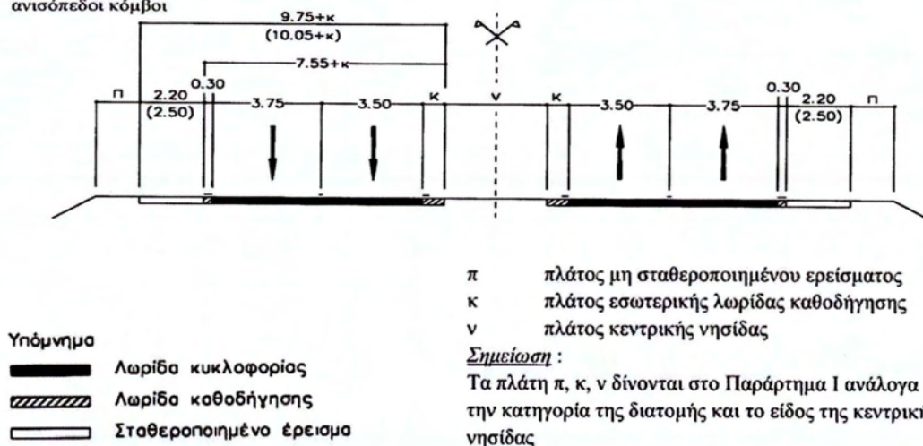
Σχήμα 4.1 Τυπική διατομή οδού α4νσ ( διαχωρισμένη επιφάνεια κυκλοφορίας) [1].
