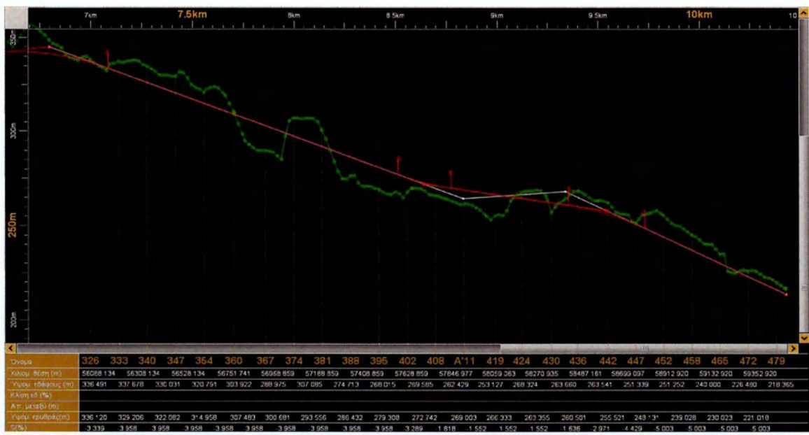
Σχήμα 5.5 Τμήμα μηκοτομής αυτοκινητοδρόμου (μετά τη βελτίωση)
