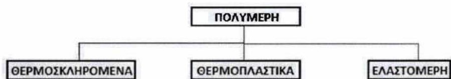
Σχ. 3 - Κατάταξη πολυμερών βάσει των μηχανικών τους ιδιοτήτων σε υψηλές θερμοκρασίες
