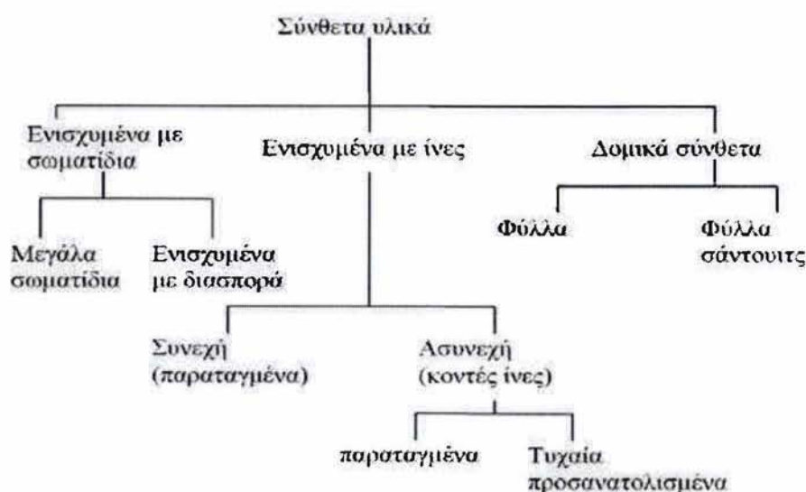
Σχ. 6 - Ταξινόμηση των διαφόρων τύπων σύνθετων υλικών
