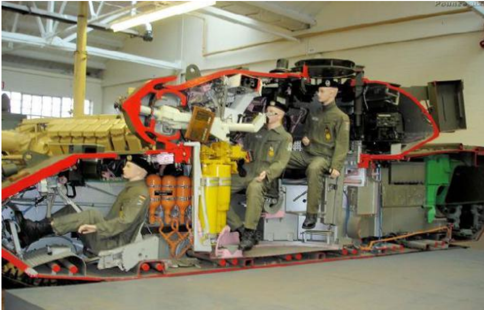
Εικόνα 1.2: Κάθετη Τομή του άρματος Leopard 1 A5.
