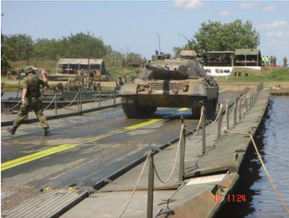
Εικόνα 1.4: Άρμα μάχης Leopard 1A5 πραγματοποιεί διέλευση πλωτής γέφυρας RIBBON στο Κέντρο Εκπαίδευσης Πλωτών Μέσων (ΚΕΠΜ) τον Ιούλιο 2010, στην Περιοχή Ευθύνης της XII Μηχανοκίνητης Μεραρχίας Πεζικού στο Δέλτα του Ποταμού Έβρου.
