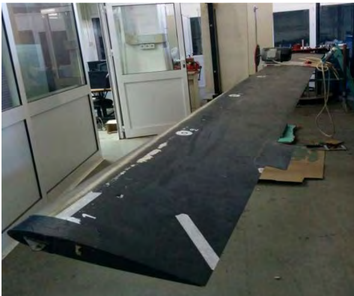
Σχήμα 3.1 Φωτογραφία ολόκληρης της πτέρυγας που είναι εγκατεστημένη στο εργαστήριο.
