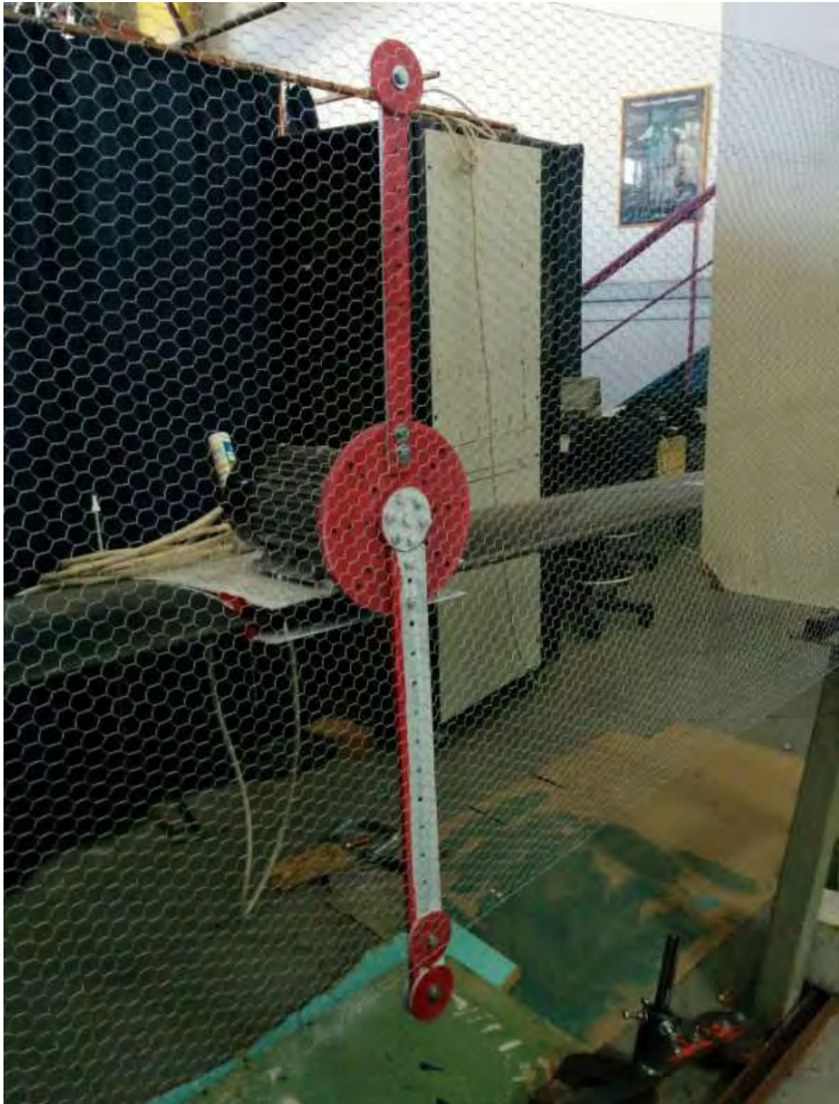
Σχήμα 3.4 Το σύστημα του διεγέρτη και η προστατευτική του διάταξη.
