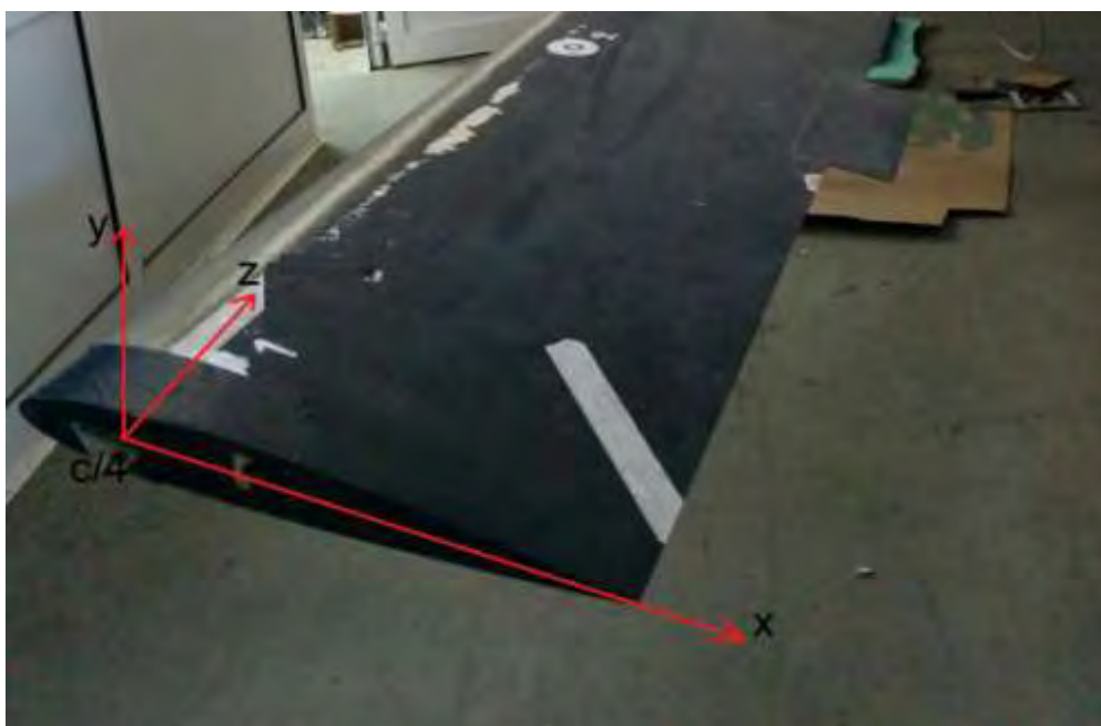
Σχήμα 3.13 Φωτογραφία της πτέρυγας με σχεδιασμένο επάνω της το καρτεσιανό σύστημα συντεταγμένων για τη διεξαγωγή των πειραμάτων μέσω του προγράμματος ζωγραφική.
