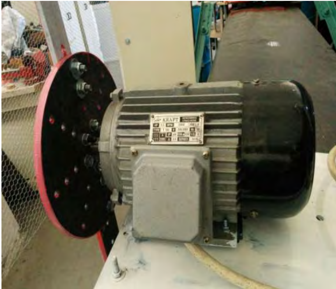
Σχήμα 3.5 Το τριφασικό μοτέρ που χρησιμοποιήθηκε για να διεγείρει την πτέρυγα και να την θέσει σε εξαναγκασμένη ταλάντωση.
