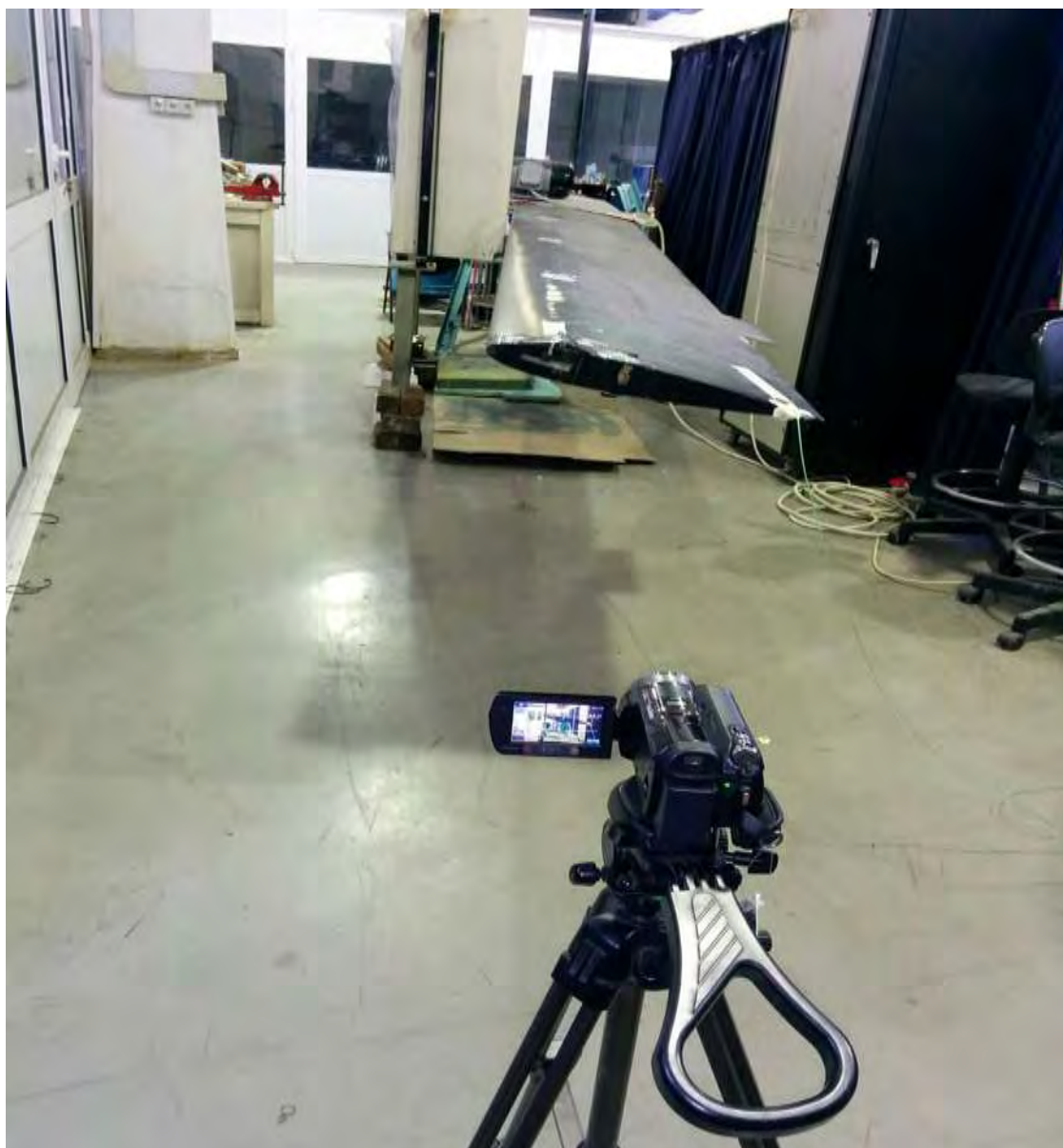
Σχήμα 3.14 Φωτογραφία της πειραματικής διάταξης της οπτικής μεθόδου ανάλυσης των ταλαντώσεων της πτέρυγας BELL HUEY II στο εργαστήριο.
