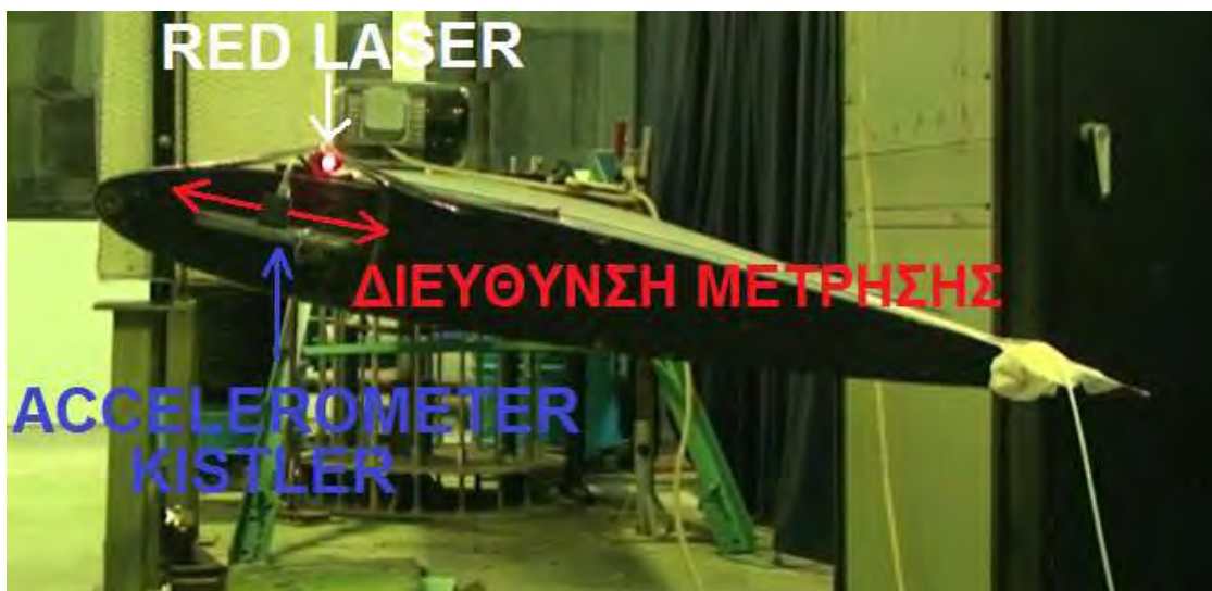
Σχήμα 3.6 Απεικόνιση της θέσης του κόκκινου λέιζερ, του επιταχυνσιόμετρου και της διεύθυνσης μέτρησης του.
