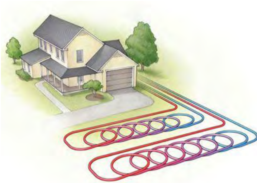
Σχήμα 11: Γεωθερμικό κύκλωμα Αντλίας Θερμότητας ( thermansinews.blogspot.gr )
