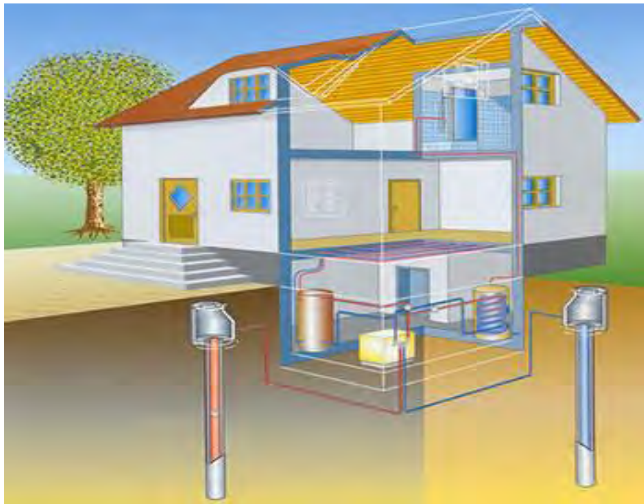
Σχήμα 12: Ανοικτό Γεωθερμικό Σύστημα οικιστικό ( http://geoergo.gr/geothermia_egkatastasi.html )
