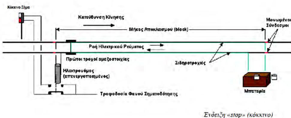
Σχήμα 2.6: Περιγραφή κατειλημμένου κυκλώματος γραμμής
