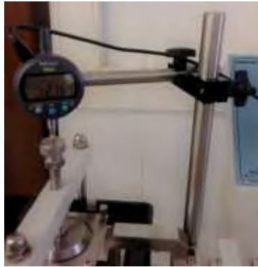
Σχήμα 3.30 Επαφή του κατακόρυφου μηκυνσιόμετρου με τον κοχλία που συνδέεται με το καπάκι
