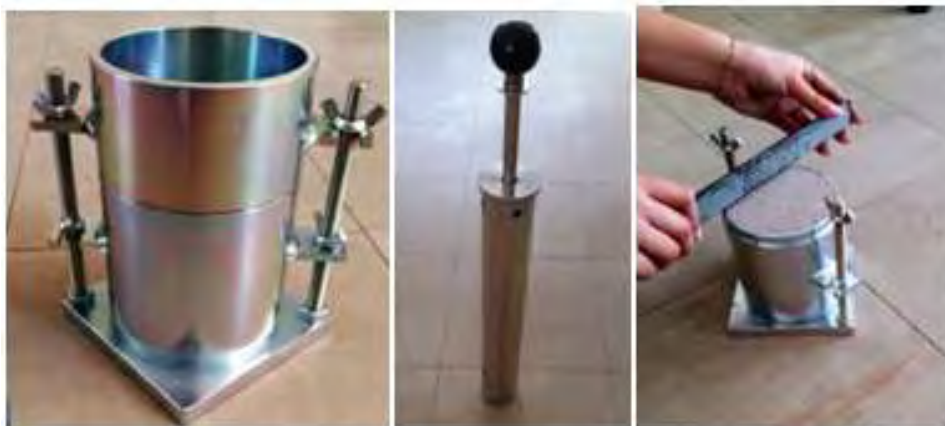
Σχήμα 3.43 Εξοπλισμός δοκιμής πρότυπης συμπίκνωσης. Από αριστερά προς τα δεξιά: μεταλλική μήτρα, μεταλλική σφύρα συμπίκνωσης και εργαλείο ομαλοποίησης της επιφάνειας(μεταλλικός χάρακας)
