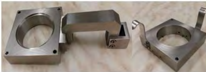
Σχήμα 3.6 Κιβώτιο διάτμησης α) κάτοψη β) τομή
