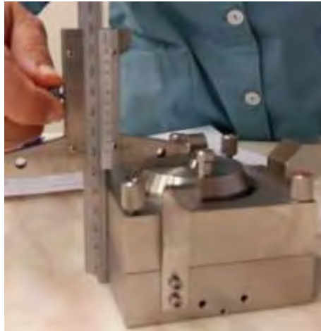
Σχήμα 3.27 Προσδιορισμός μετρηθέν ύψους με χρήση αναλογικού βαθύμετρου
