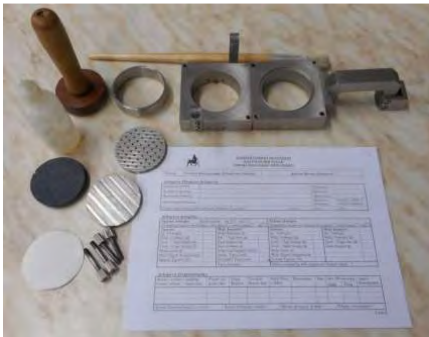
Σχήμα 3.26 Προετοιμασία εξοπλισμού δοκιμής άμεσης διάτμησης
