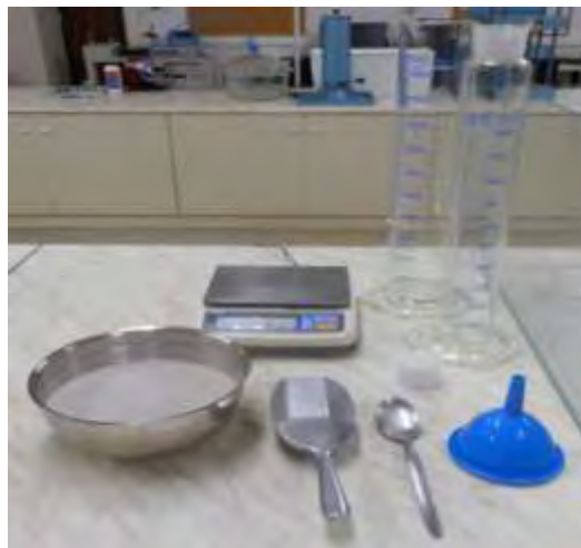
Σχήμα 3.41 Εξοπλισμός δοκιμής ελάχιστης πυκνότητας με τη μέθοδο ξηρής εναπόθεσης σε ογκομετρικό σωλήνα χωρίς νερό
