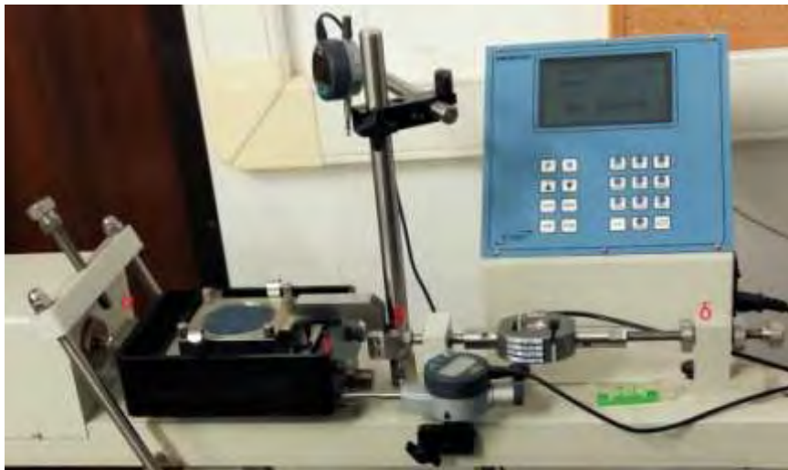
Σχήμα 3.28 Ρύθμιση θέσης κιβωτίου (τέσσερα σημεία επαφής)
