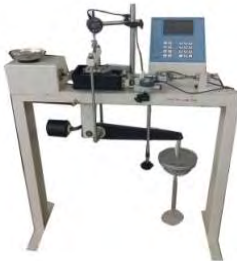
Σχήμα 3.1 Συσκευή άμεσης διάτμησης τύπου VJT9500 του Εργαστηρίου Εδαφομηχανικής του Πανεπιστημίου Θεσσαλίας
