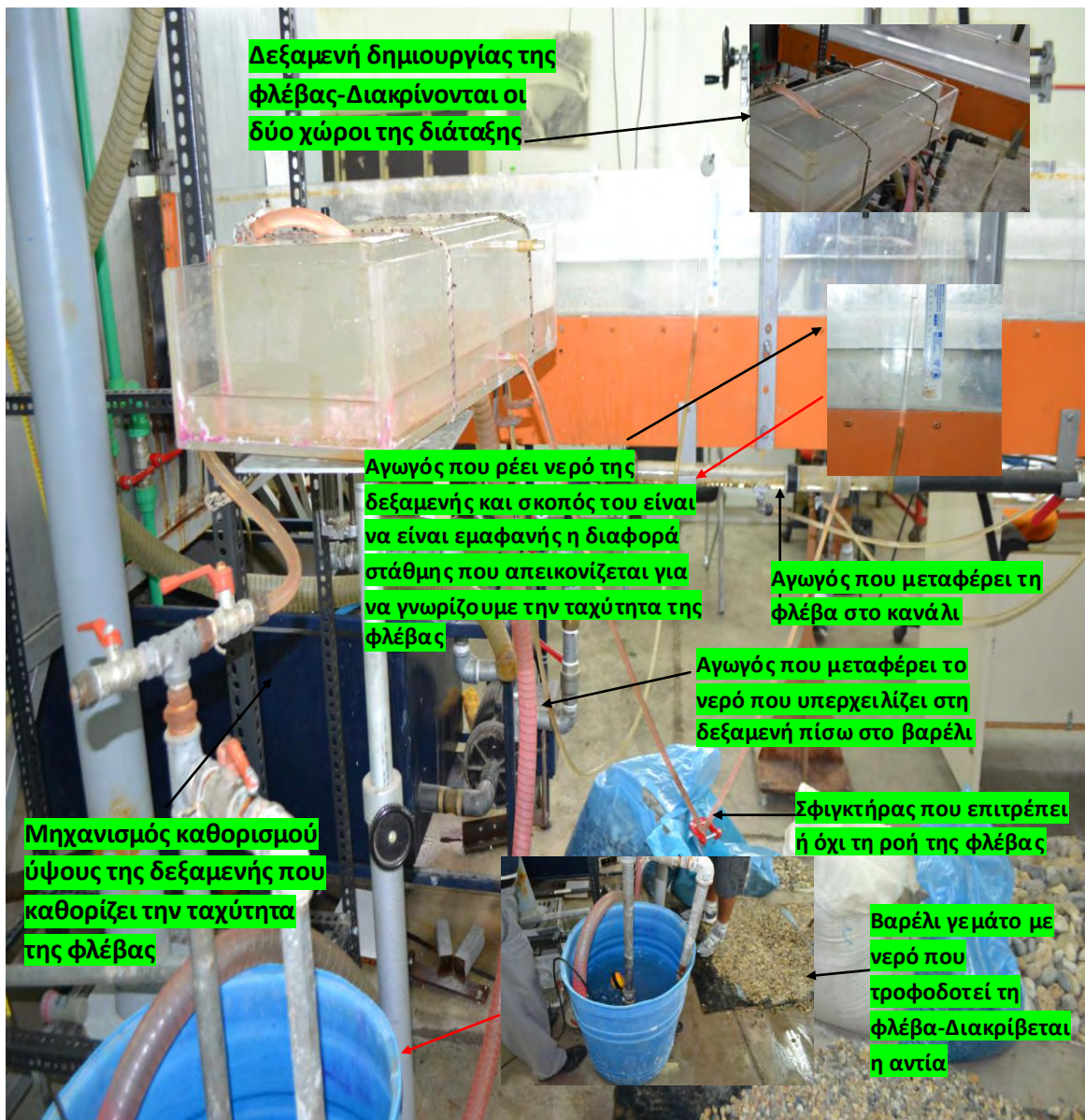
Εικόνα 3.4 Χαρακτηριστικές λεπτομέρειες συστήματος δημιουργίας της φλέβας
