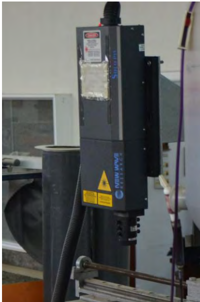
Εικόνα 4.2.1.1.2 Συσκευή λέιζερ-Διακρίνονται και οι φακοί για τη μεταποπή της δέσμης σε επίπεδο φωσ
