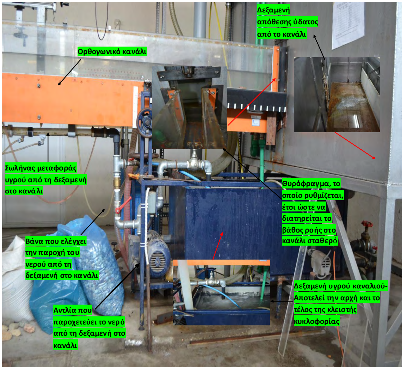
Εικόνα 3.2 Χαρακτηριστικές λεπτομέρειες συστήματος δημιουργίας ευθύγραμμης ροής
