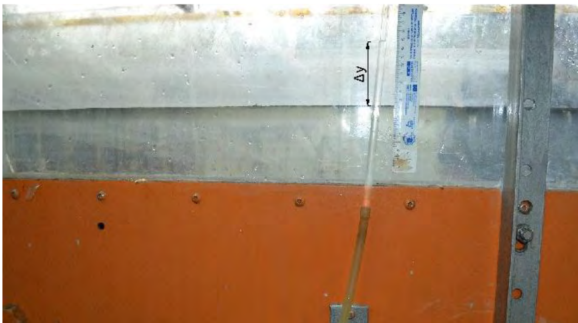
Εικόνα 4.4.2 Απεικόνιση της τιμής \Delta y που μετρήθηκε στο εργαστήριο και καθόρισε την ταχύτητα εκτόξευσης της φλέβας
