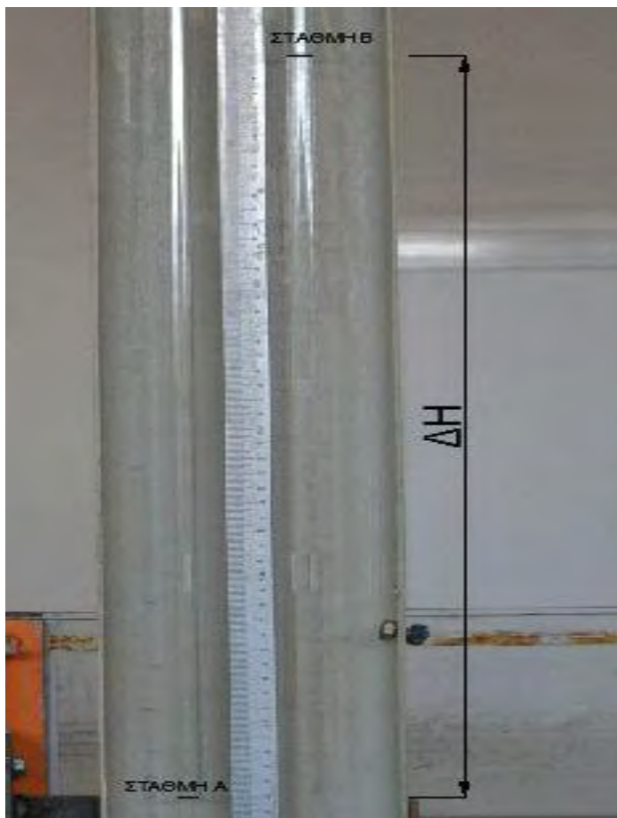
Εικόνα 4.4.3 Απεικόνιση της τιμής \Delta h που μετρήθηκε στο μανόμετρο του εργαστηρίου και καθόρισε την ταχύτητα της ευθύγραμμης ροής
