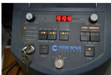
Εικόνα 4.2.1.1.1 Απεικόνιση συσκευής που ελέγχει την παραγωγή παλμών του λέιζερ
