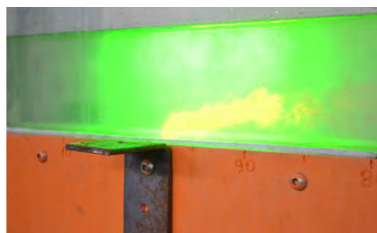
Εικόνα Α.5 Φυσικό φαινόμενο-Τυρβώδης ανωστική φλέβα σε ευθύγραμμη εγκάρσια ροή
