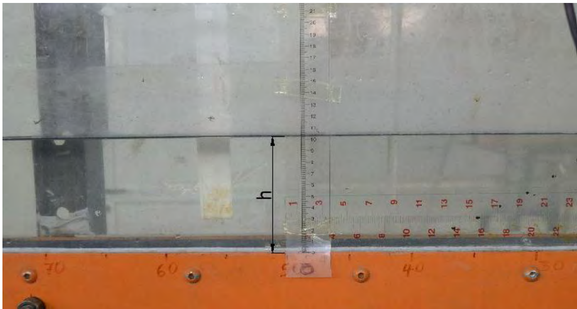
Εικόνα 4.4.1 Απεικόνιση της τιμής h που μετρήθηκε στο εργαστήριο και καθόρισε το βάθος ροής
