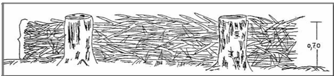
Εικόνα 17. Ρόγγισμα(κλαδοσωροί) -πρόσοψη από κατάντη
