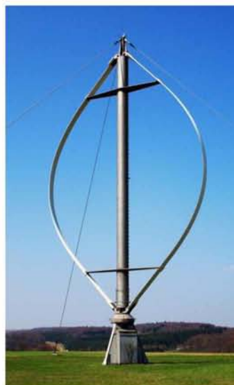
Εικόνα 8 : Ανεμογεννήτριες οριζόντιου και κατακόρυφου άξονα
