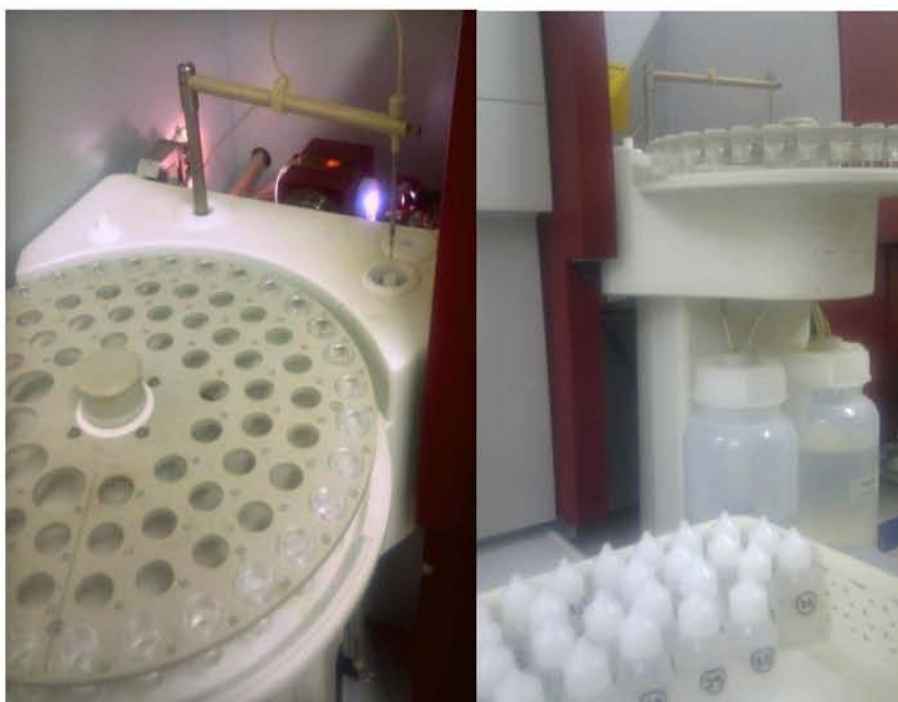
Εικόνα 12 : Ατομική απορρόφηση με φούρνο γραφίτη (Graphite Furnace AAS, GFAAS)
