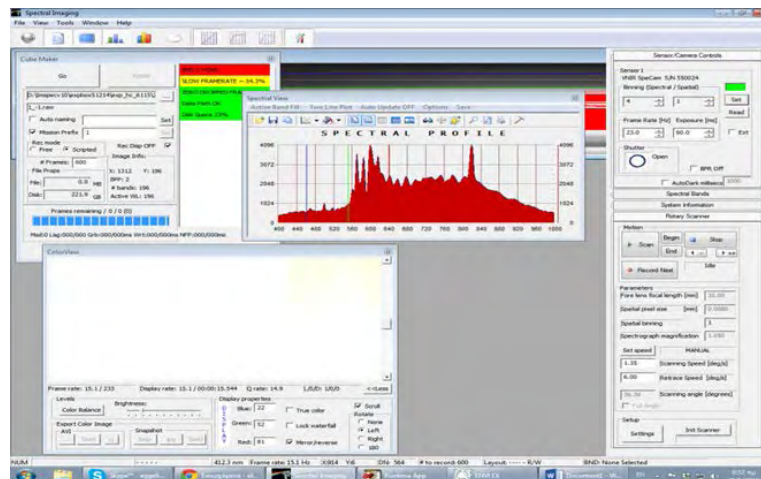
Εικόνα 14. Display προγράμματος DAQ για τον υπολογισμό του λευκού στόχου
