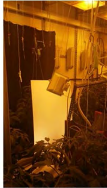
Εικόνα 17. Απεικόνιση του εσωτερικού του θαλάμου ανάπτυξης φυτών σε προσπάθεια καταγραφής λευκού στόχου με τη χρήση της υπερφασματικής κάμερας
