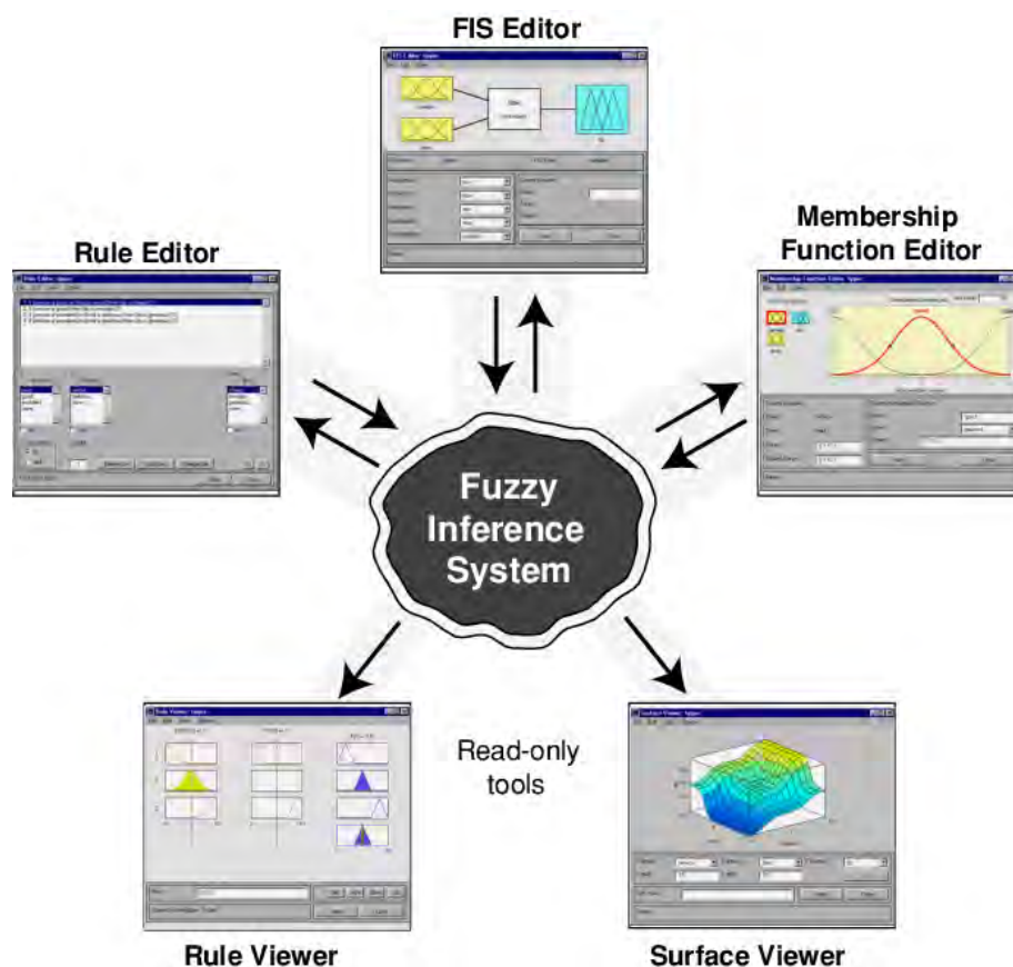
Εικόνα 5.3. Η εργαλειοθήκη ασαφούς λογικής του MATLAB αποτελείται από εργαλεία σε γραφικό περιβάλλον (MathWorks, 2016).
