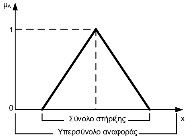
Εικόνα 3.13. Παράδειγμα τριγωνικού ασαφούς συνόλου (Κινγκ, 2004, fig. 5.2).
