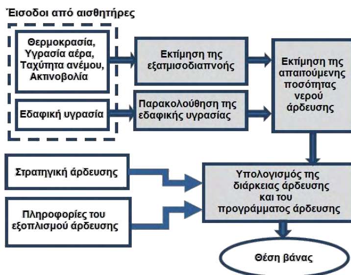
Εικόνα 4.7. Δομή του μοντέλου υποστήριξης αποφάσεων. Τροποποιημένη (Mousa et al., 2014, fig. 1).
