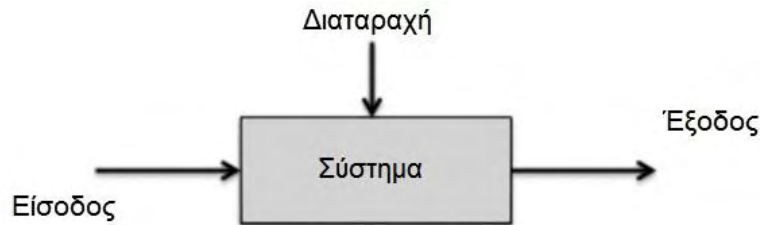
Εικόνα 3.1. Σύστημα ανοικτού βρόχου, χωρίς ανατροφοδότηση. Τροποποιημένη (Romero et al., 2012).
