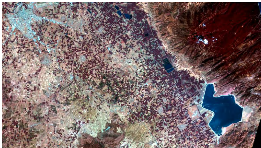
Εικόνα 5.12 Δορυφορική εικόνα SPOT χωρικής ανάλυσης 20μ. για τη χαρτογράφηση των ορίων της λίμνης Κάρλας.
