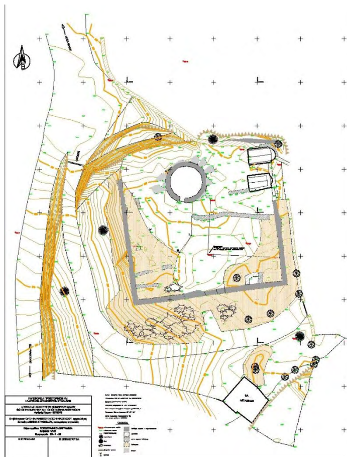
Εικόνα 3.2 Τοπογραφική αποτύπωση του περιβάλλοντος χώρου του πύργου Χειμάρρου Νάξου (Αστρολάβος 2012).
