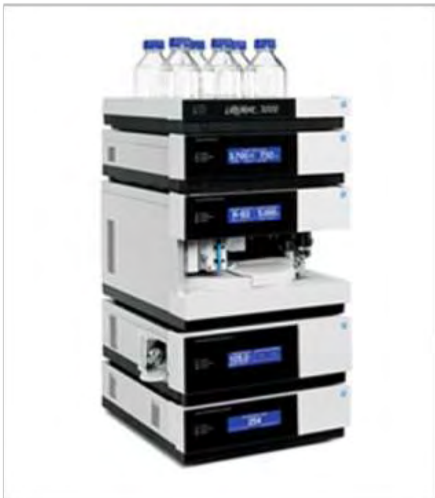
Εικόνα 6 :Σύστημα ΥΓΡΗΣ ΧΡΩΜΑΤΟΓΡΑΦΙΑΣ DIONEX MODEL ULTIMATE 3000 με ανιχνευτή PDA.
