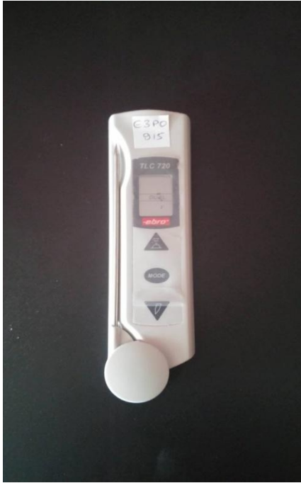
Εικόνα 1. Ειδική συσκευή υπέρυθρης καταμέτρησης θερμοκρασίας.
