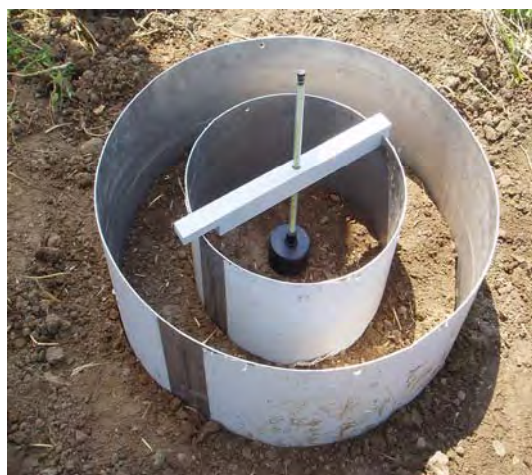
Εικόνα 5. Διηθητικόμετρο διπλού δακτυλίου (αριστερά) και σχηματικά η τοποθέτησή του σε κάτοψη (δεξιά).
