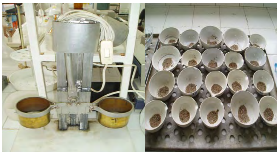
Εικόνα 4. Συσκευή υγρής κοσκίνισης (αριστερά) και δείγματα εδάφους έτοιμα για υγρή κοσκίνιση (δεξιά).
